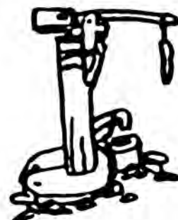
Studna – pístová dřevěná, pumpa vrtaná v kmenu
