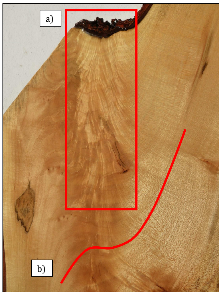
Obr. 10 Spojení větve a kmene. a) Na vrchní straně větvení pletiva větve a kmene vytlačují korní hřebínek, b) pletiva kmene se překrývají s pletivy větve.
