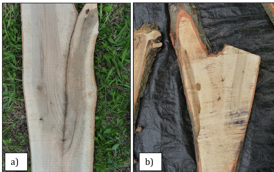
Obr. 14 a) Tlakové větvení se zarůstající kůrou, b) tahové větvení, kdy dochází k propojení pletiv větve a kmene a vytlačování korního hřebínku.
