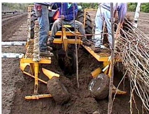
školkovací/přesazovací stroj (výška přesazovaných jedinců až 4 m)
