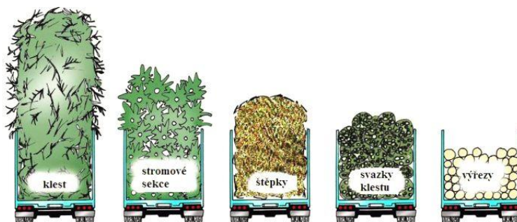
Obr. 15.12. Srovnání využití odvozní kapacity vozidla při transportu různého materiálu (John Deere)
