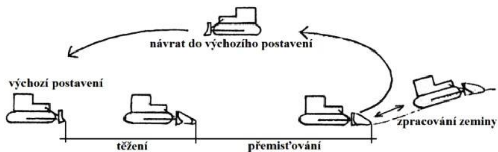
Obr. 16.19. Schéma teoretického pracovního cyklu dozeru
