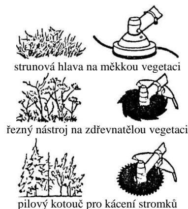
Obr. 7.11. Typy řezných orgánů a jejich použití
