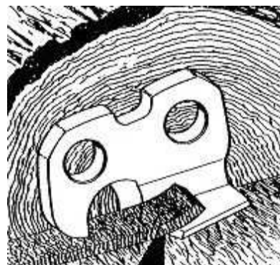
Obr. 11.4. Princip hoblovacího zubu
