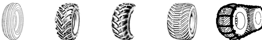
Obr. 6.11. Vzorky běhounů pneumatik a kolopás na pneumatikách s lomenými lamelami
