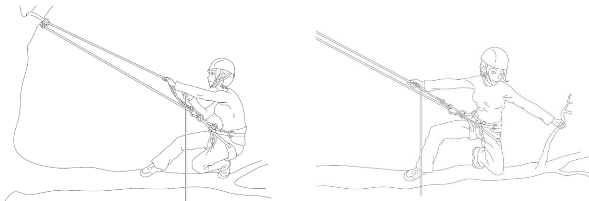
Obr. 12.17. Pracovní polohování při metodě dvojitého lana
