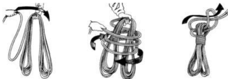
Obr. 20.34. Postup skládání textilního lana do svitku
