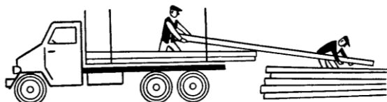
Obr. 20.43. Ruční nakládání dlouhého dříví provlékáním mezi klanice
