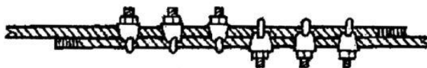
třmen svorky je vždy na straně konce lana, na každé straně je plný počet svorek Obr. 20.26. Spojování ocelových lan šroubovými lanovými spojkami
