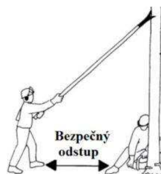
Obr. 11.21. Použití přetlačné tyče pro vychylování stromů
