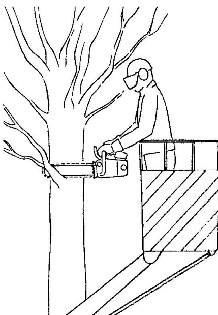
Obr. 11.34. Práce s pilou v koruně stromu z vysokozdvížné plošiny
