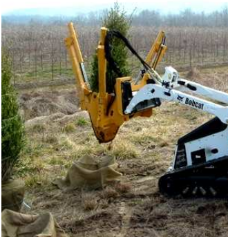
Obr. 8.7. Adaptér pro přebalování kořenových balů jutovým vakem
