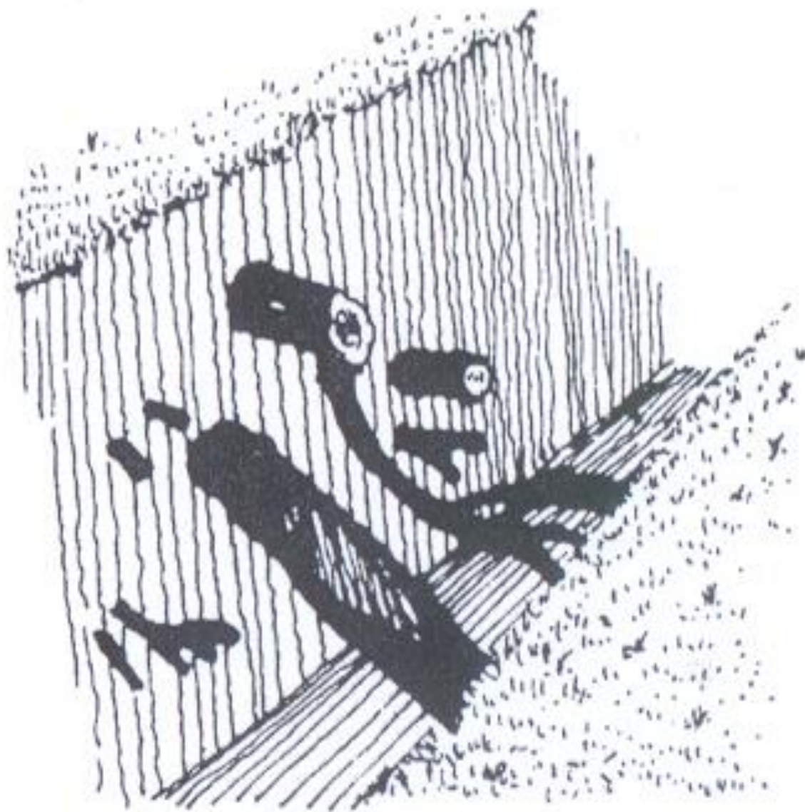
Hloubení výkopu v kořenovém prostoru stromu (3.9.2)
