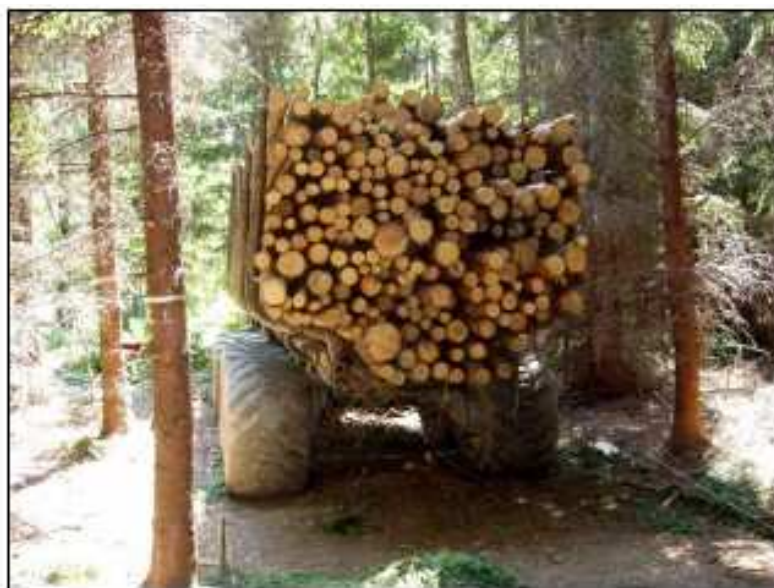
Obr. 2: Traktor TIMBERJACK Mini Bruunett s nákladem (zátěží na kolo 2 400 kg) použitý jako modelové zatížení smrkových kořenů (měrný tlak na půdu 1.1 kg m -2 ).
