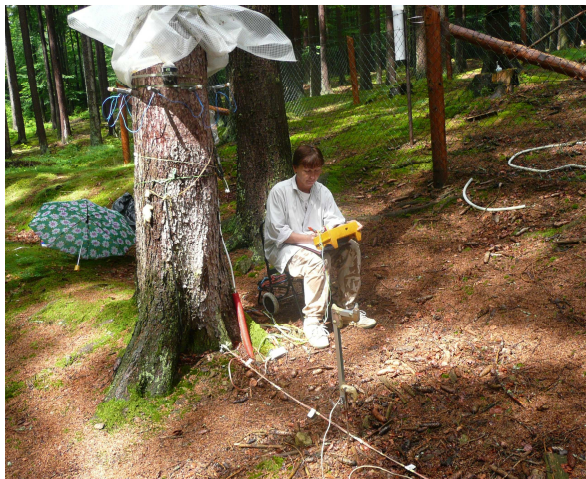
Obr.3. Měření aktuální (v okamžiku měření funkční) absorpční plochy kořenů smrku (v \text{m}^2 na určitou sekci nebo na celý strom) metodou modifikované elektrické impedance půdy (Aubrecht et al. 2006, Čermák et al. 2006). Na obrázku je vidět jednu sérii proudových elektrod na kmeni a pohyblivou potenciální elektrodu podél kabelu uloženého v radiálním směru od kmene k druhé sérii proudových elektrod v půdě.
