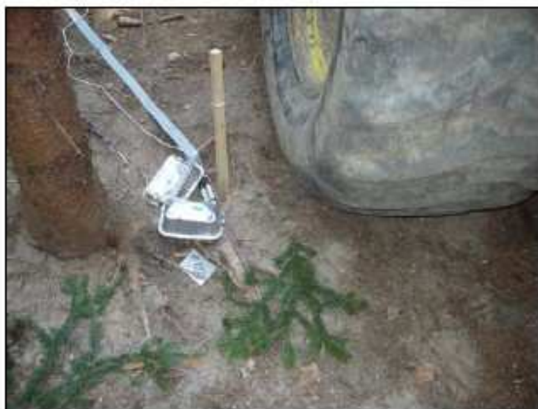
Obr. 3: Detail umístění čidel transpiračního proudu a pohybujícího se kola naloženého traktoru
