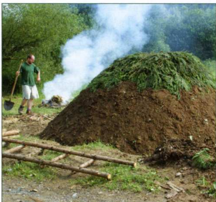
Pokryvání milíře svrchním pláštěm (Pec pod Čerchovem - Dřevorubecké slavnosti 2009).
