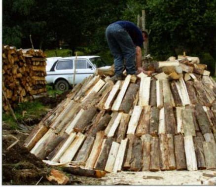
Stavba milíře (Pec pod Čerchovem - Dřevorubecké slavnosti 2009).
