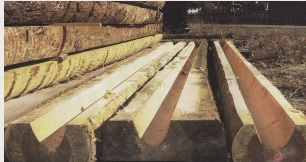
Příčné odvodnění zemní pláně svodnicemi
