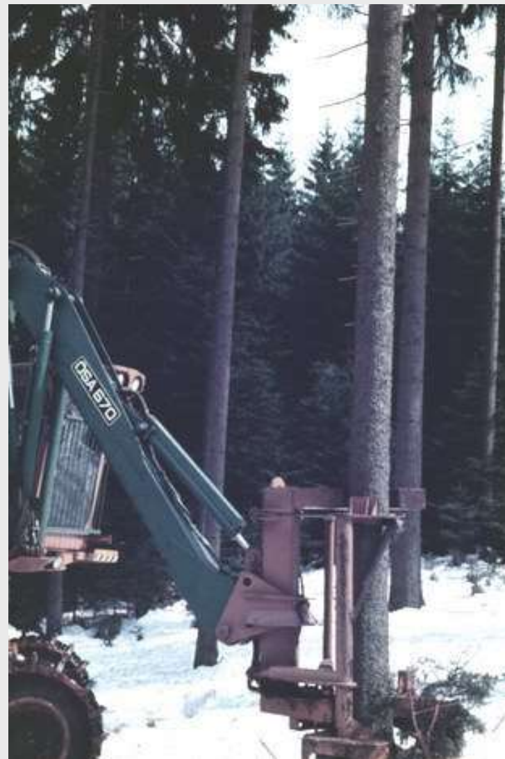
Vynášení stromů ze zmlazení kácecím strojem
