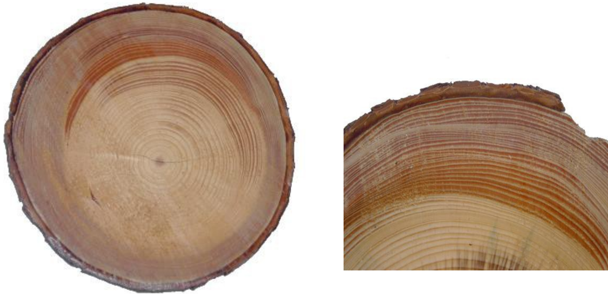
Vzhled tlakového dřeva, smrk
