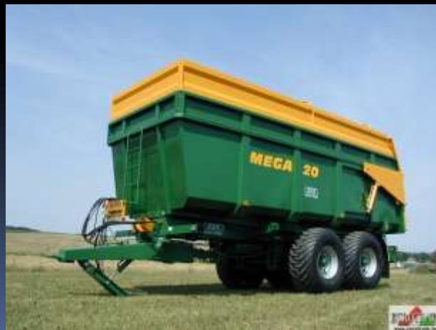
traktorový návěs MEGA 20 – největší povolená hmotnost 20 t, užitečná hmotnost 14,82 (t)
