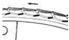
Pilovité opotřebení dezénových bloků
