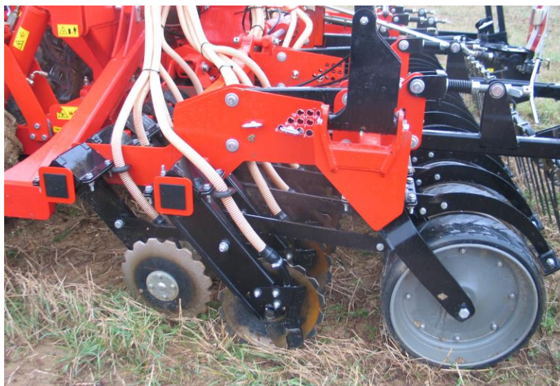
Obrázek 29: Jednokotoučové botky secího stroje s plynulým výsevem (foto: HŮLA)
