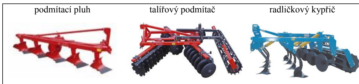
Obrázek 4: Typy strojů používaných k podmítce
