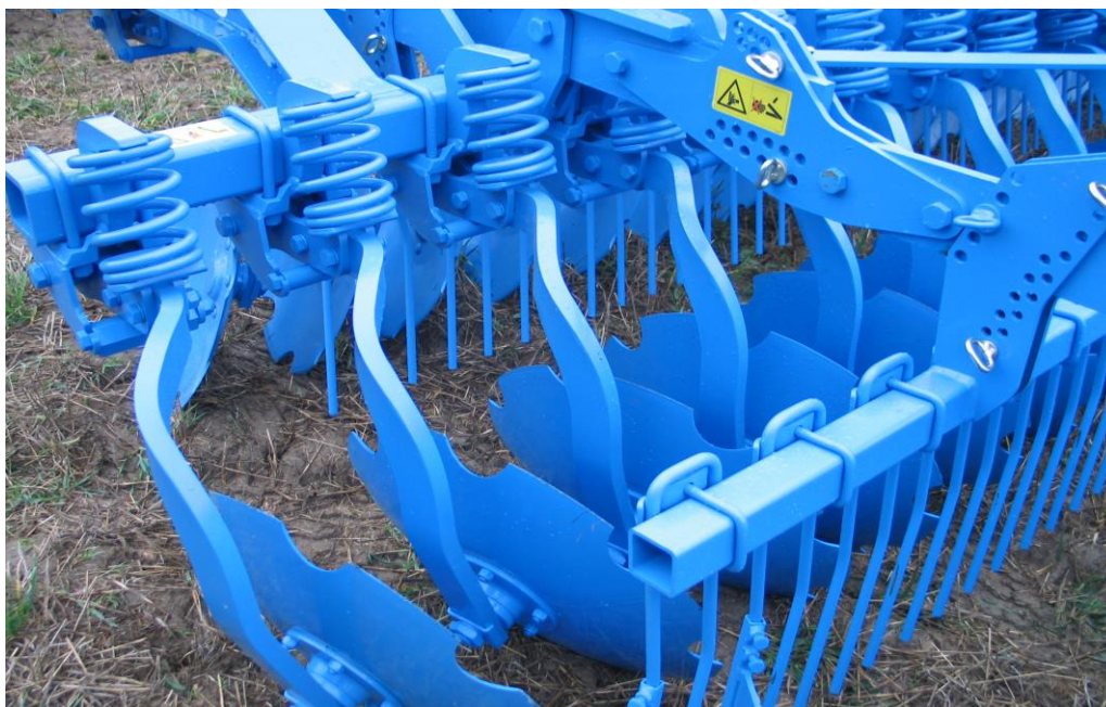
Obrázek 26: Detail talířového kypříče s talíři na samostatných slupicích (foto: HŮLA)
