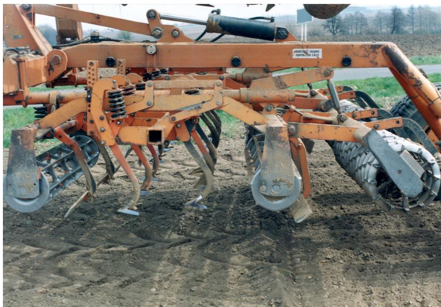
Obrázek 27: Kombinátor s nepoháněnými pracovními nástroji (foto: HŮLA)
