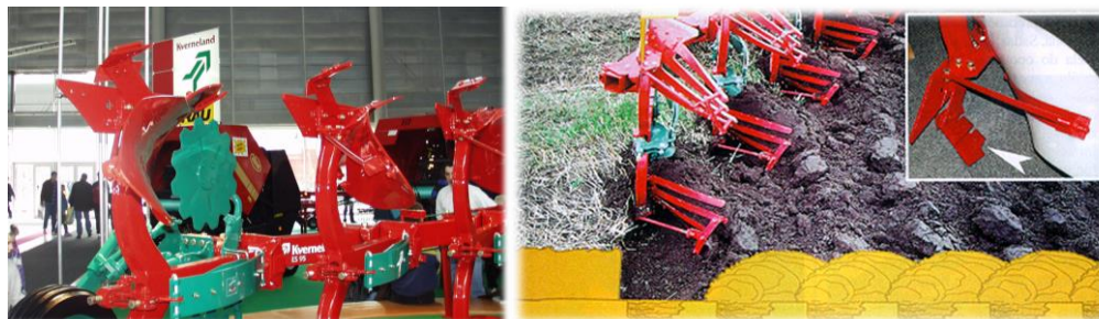
Obrázek 14: Pluh vybavený podrývací radličkou
