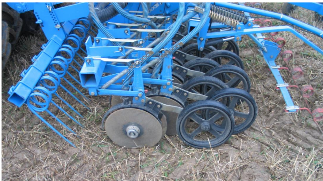
Obrázek 30: Dvoukotoučové botky secího stroje s plynulým výsevem s předřazenou sekčí prutových bran, kopírovacími a přítlačnými koly a zavlačovačem (foto: HŮLA)
