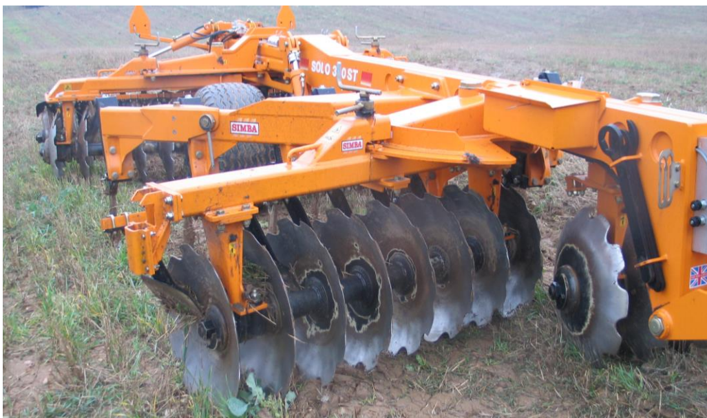
Obrázek 25: Talířový kypříč – sady talířů na společných hřídelích (foto: HŮLA)
