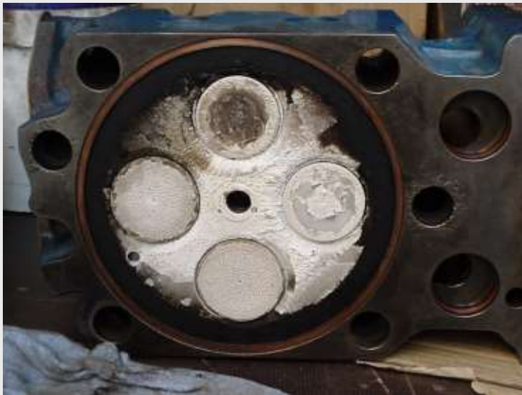
Hlava válce poškození křemík
