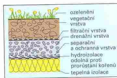
Obr. 3: Způsob provedení zelených střech
