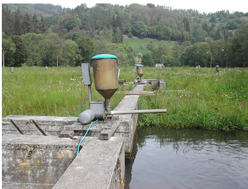
Obr. 12: Použití krmítka využívajícího stlačený vzduch.
