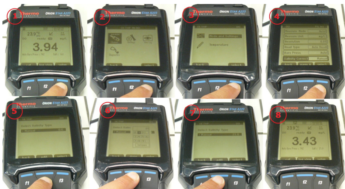
Obrázek č. 5: Vložení hodnoty salinity do měřícího přístroje
