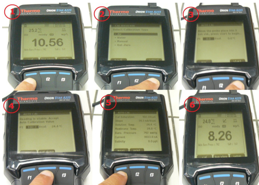
Obrázek č.4: Kalibrace přístroje vzduchem nasyceným vodou
