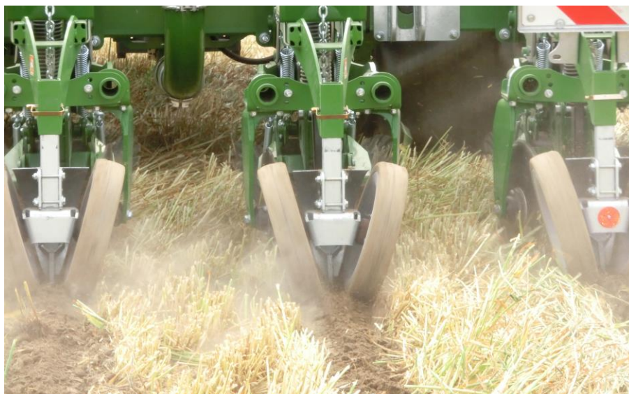
Obrázek 32: V sortimentu strojů na přesné setí jsou i stroje, které lze využít po tzv. pásovém zpracování půdy – zejména při pěstování kukuřice se jedná o významný přínos k protierozní ochraně půdy (foto: HŮLA)
