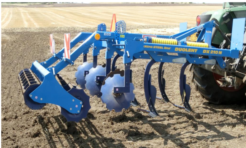
Obrázek 24: Radličkový kypřič nesený – talíře v tomto případě nejsou určeny ke kypření, ale k drobení a mísení (foto: HŮLA)
