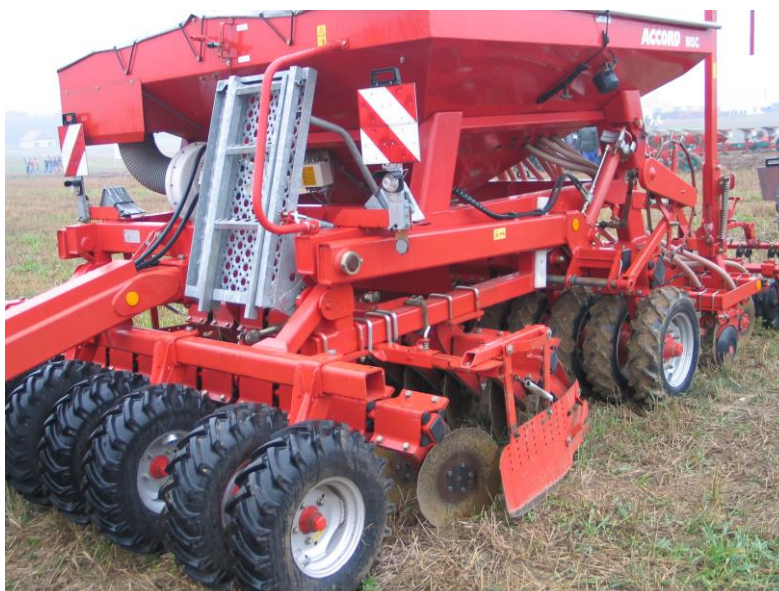
Obrázek 31: Secí kombinace - stroje spojující přípravu půdy se setím – v tomto případě jsou pro přípravu půdy určeny nepoháněné pracovní nástroje (foto: HŮLA)
