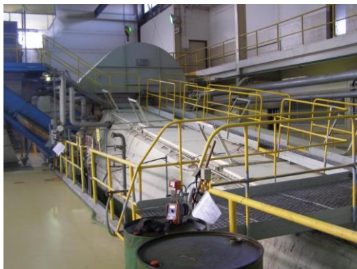
Obr. 86: Schéma žlabového extraktoru Obr. 87: Žlabový extraktor s řízkolisem
