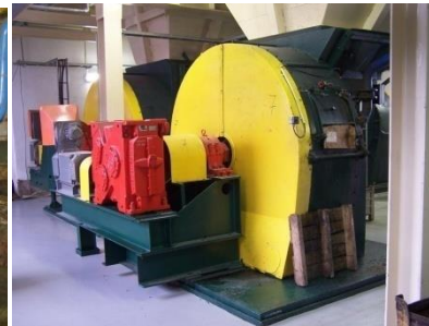
Obr. 79: Sestava nožů pro bubnovou řezačku a bubnové řezačky
