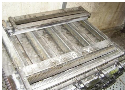
Obr. 79: Sestava nožů pro bubnovou řezačku a bubnové řezačky
