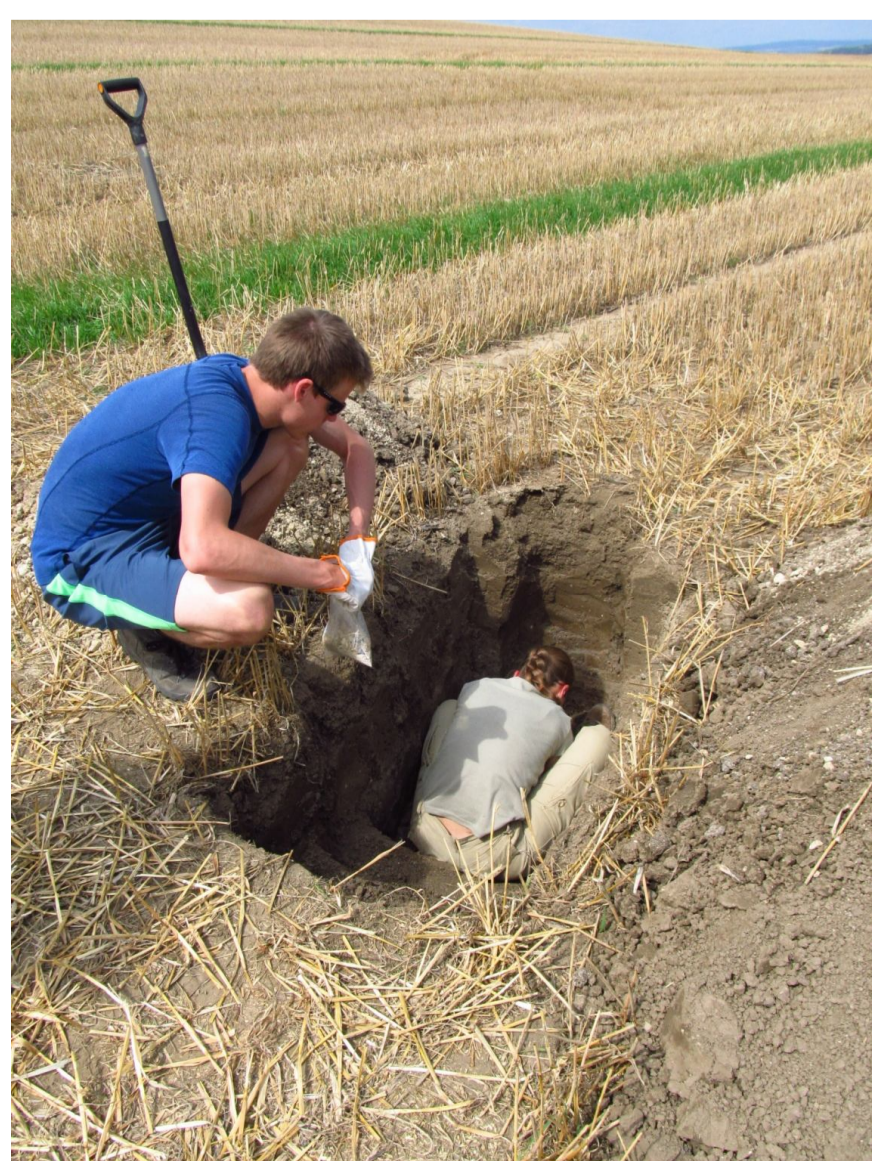
Obr. 3 Odběr půdních vzorků ze sondy
