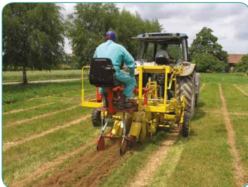
Obr. 7.40: Pásový secí stroj upravený pro maloparcelkové experimenty
