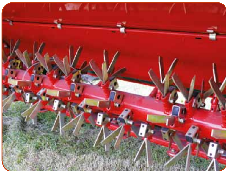
Obr. 12.3: Kondicionéry mechanicky naruší posečený rostlinný materiál
