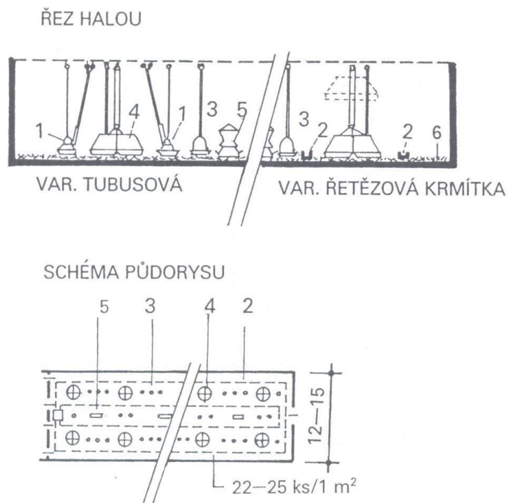
Obrázek 32: Výkrm kuřat (brojlerů) na podestýlce (1 – tubusové krmítko, 2 – řetězové krmítko, 3 – klobouková napáječka, 4 – elektrická kvočna, 5 – krmítko na grit, 6 – podestýlka)
