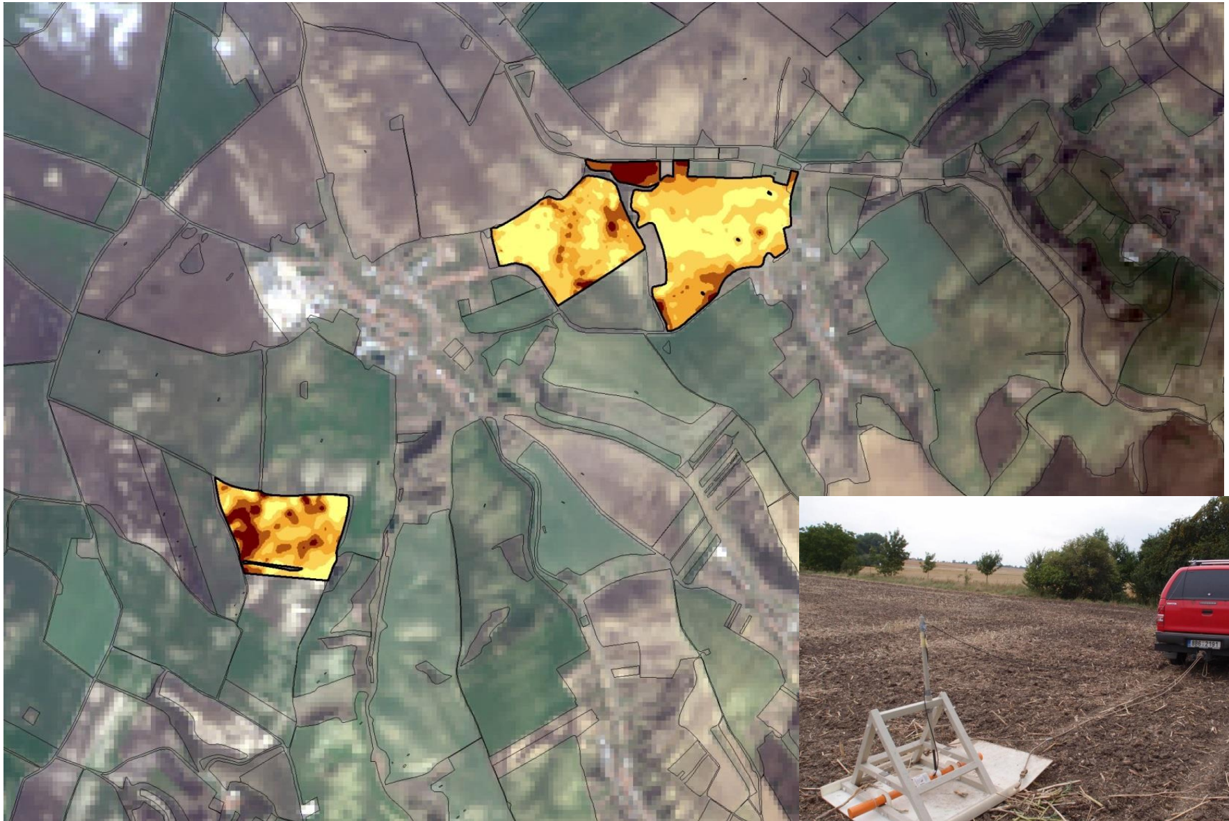
k.ú. Otnice (Újezd u Brna) – měření elektrické vodivosti půdy
