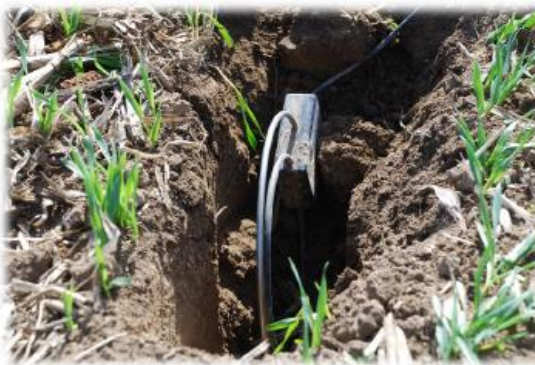
Instalace vlhkoměru VIRRIB
