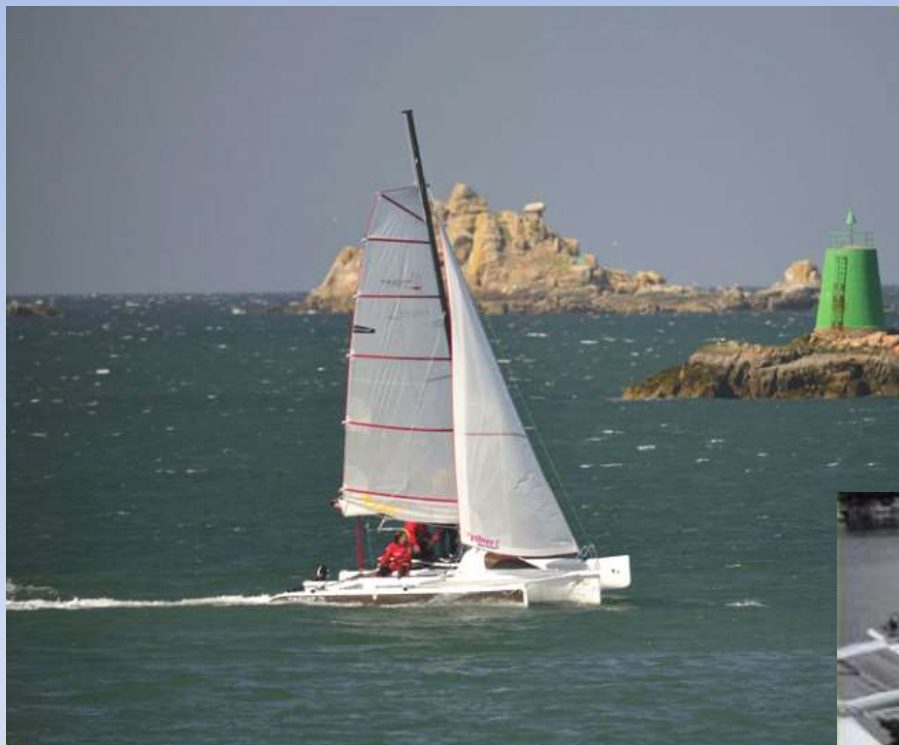
7 m trimaran ze lněného biokompozitu (2013)
