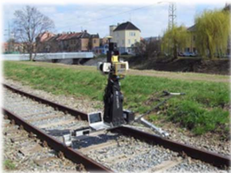
Ukázka systémů mobilního mapování (převzato z www.cad.cz ).
