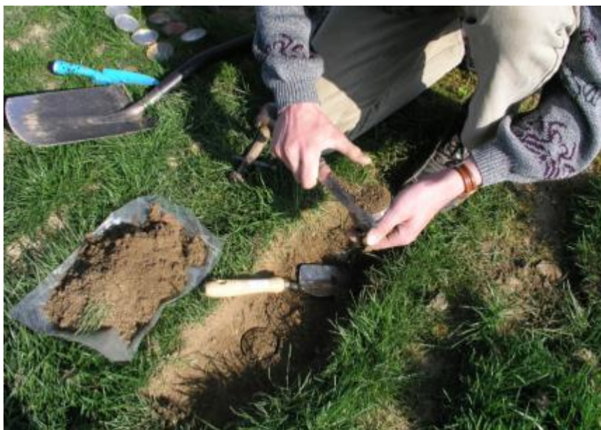
Postup při odběru neporušených vzorků půdy
