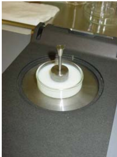
Měření vzorků mléka na integrační sféře přístroje pomocí kovového zrcátka
