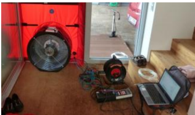
Blower door test a výstup z měření
