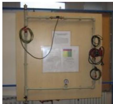
Vybavení laboratoře: Zásobník teplé vody, výukový panel – charakteristika čerpadla
