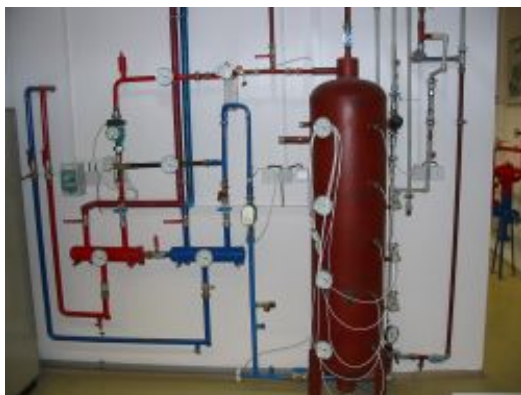
Vybavení laboratoře: Zásobník teplé vody, výukový panel – charakteristika čerpadla
