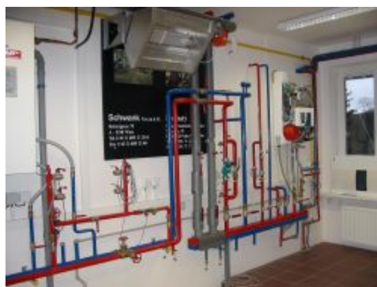
Vybavení laboratoře: okruhy vytápění
