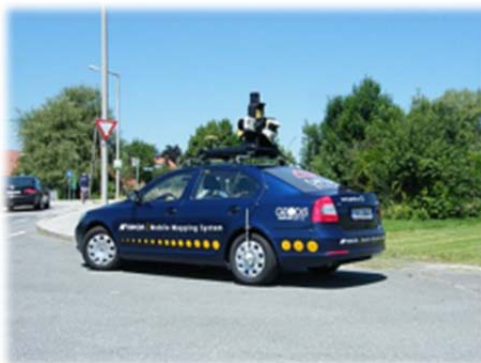
Ukázka systémů mobilního mapování (převzato z www.cad.cz ).
