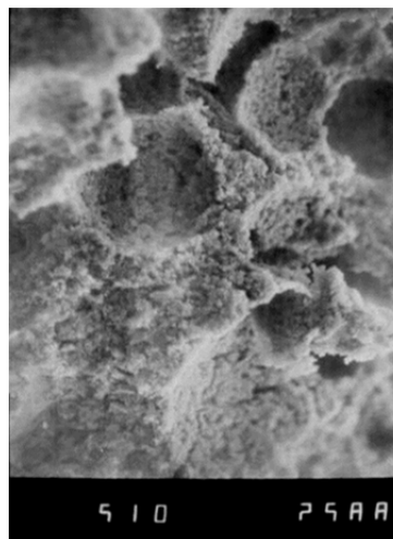
Snímek struktury cementového tmele. Zvětšeno 510 krát
