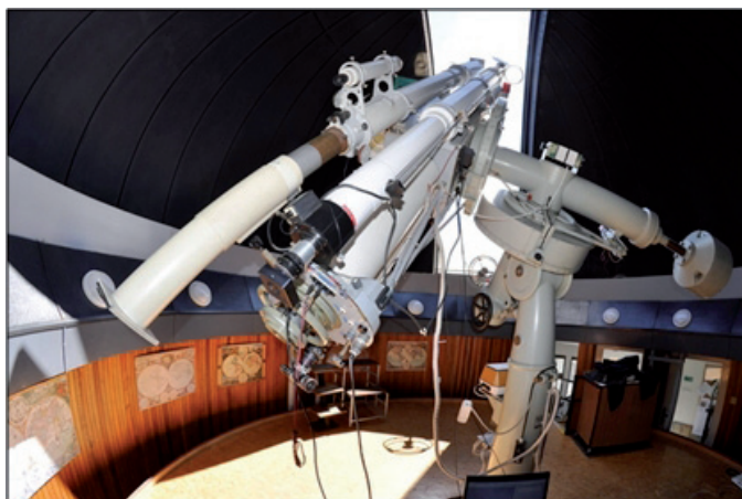
Obr. 2: Celkový pohled na soubor dalekohledů pro detailní snímkování aktivních oblastí na Slunci
