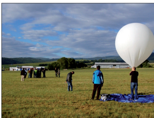
Obr. 3: Napouštění stratosférického balónu heliem pro let do stratosféry. Snímek je z letu SDS 04 realizovaného v červnu roku 2014. Zdroj: STRATO-NANOBIOLAB
