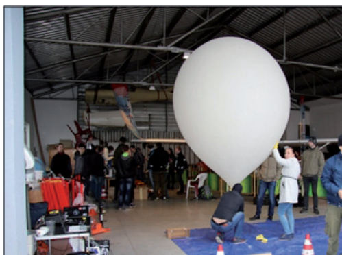
Obr. 3: Příprava a tlakování samotného stratosférického balónu heliem. Zdroj: STRATO-NANOBIOLAB
