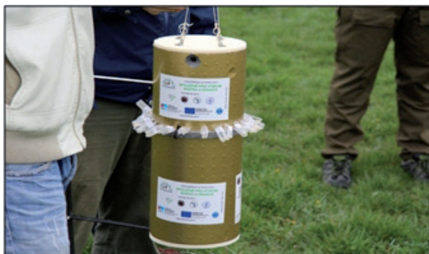
Obr. 2: Vzhled letové platformy těsně před startem. Na povrchu jsou umístěny kyvety s biologickými vzorky
