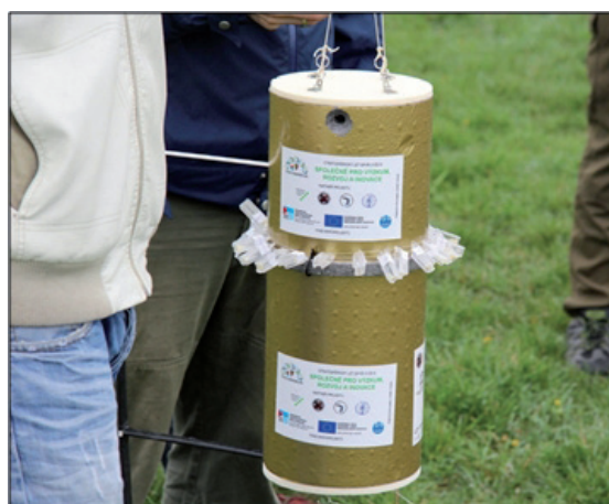
Obr. 4: Pohled na sestavenou gondolu stratosférického balónu. Na povrchu jsou dobře patrné kyvety s lyofilizovanými bakteriemi a viry. Zdroj: STRATO-NANOBIOLAB
