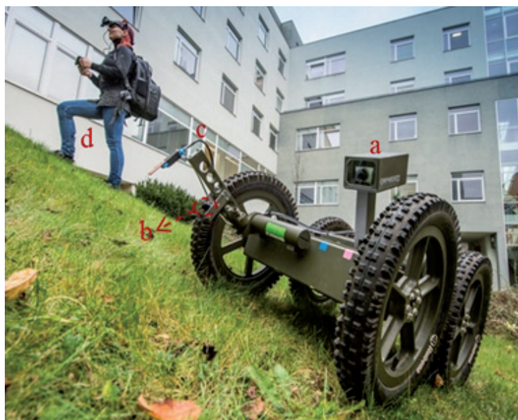
Obrázek 3: Robotická platforma ORPHEUS-HOPE a) hlavní kamera, b) malá kamera s vysokým rozlišením pro přesnou manipulaci s elektrodou, c) tištěná elektroda na pohyblivém ramenu, d) operátor [15].
