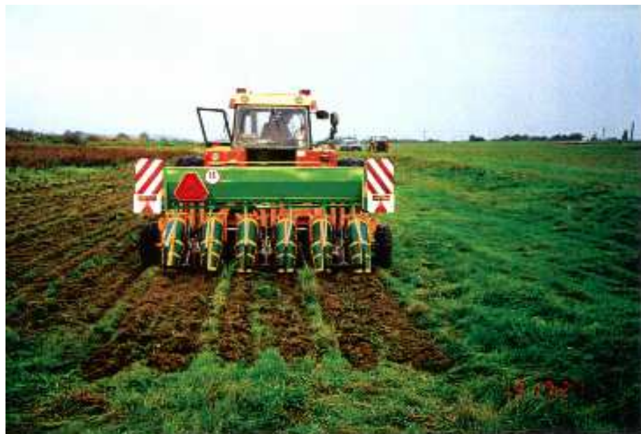
Stroj pro pásové přisevy SPP-6 ( 1 \text{ ha} \cdot \text{h}^{-1} )
