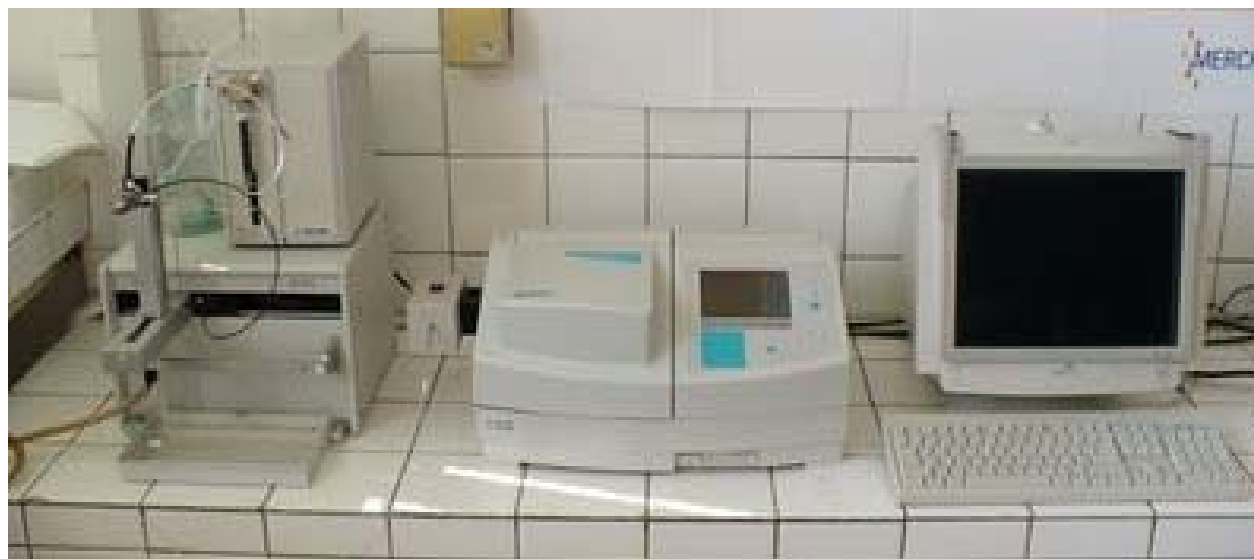
Plně automatický spektrofotometr Spectronic Unicam Aquamate s dávkovací pumpou Gilson
