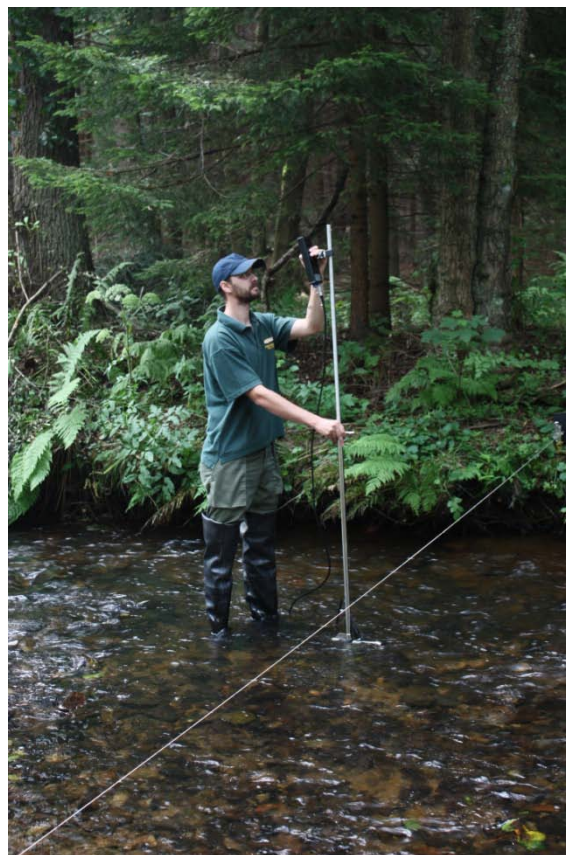
Měření průtokových charakteristik říčky Fryšávky
