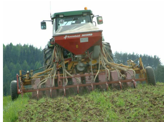
Sečí stroj pro pásové přisevy do travních porostů SPP-8
