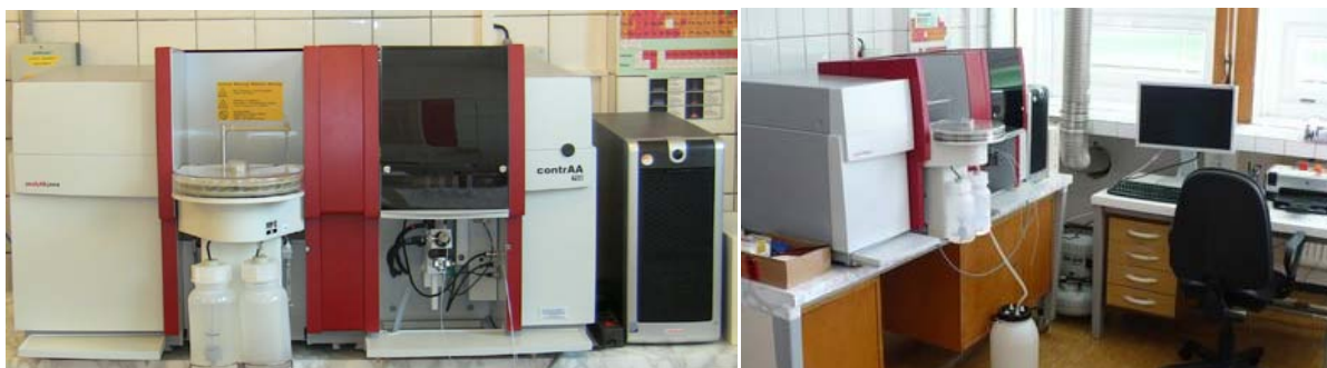
Atomový absorpční spektrofotometr ContrAA 700
