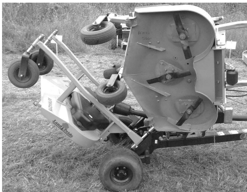
Obrázek 63: Vícerotorové provedení vertikálního mulčovače
