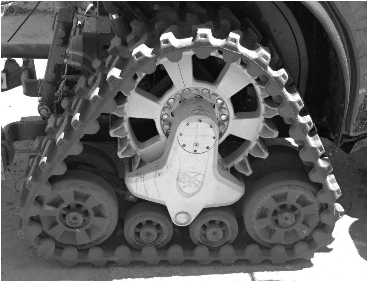
Obrázek 17: Pásový podvozek od stroje s kloubovým řízením
