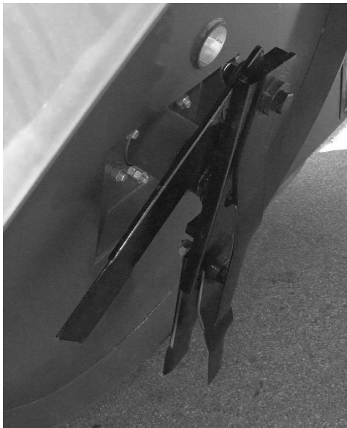
Obrázek 61: Možné řešení vícestupňového uspořádání nožů na rotoru vertikálního mulčovače
