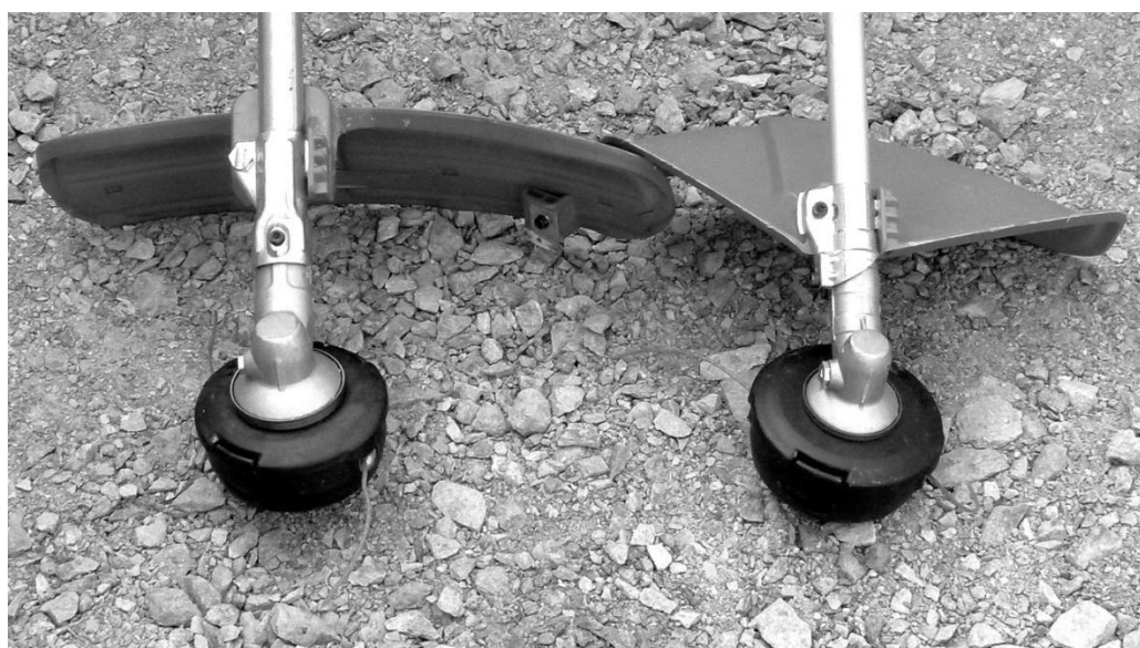
Obrázek 54: Žací ústrojí pro řez bez opory - strunová hlava
