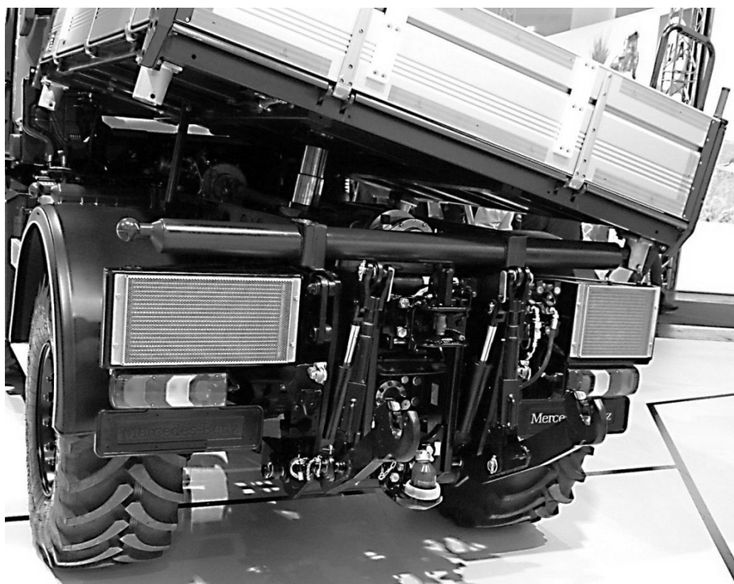
Obrázek 24: Kombinace horního a spodního závěsu na komunálním vozidle
