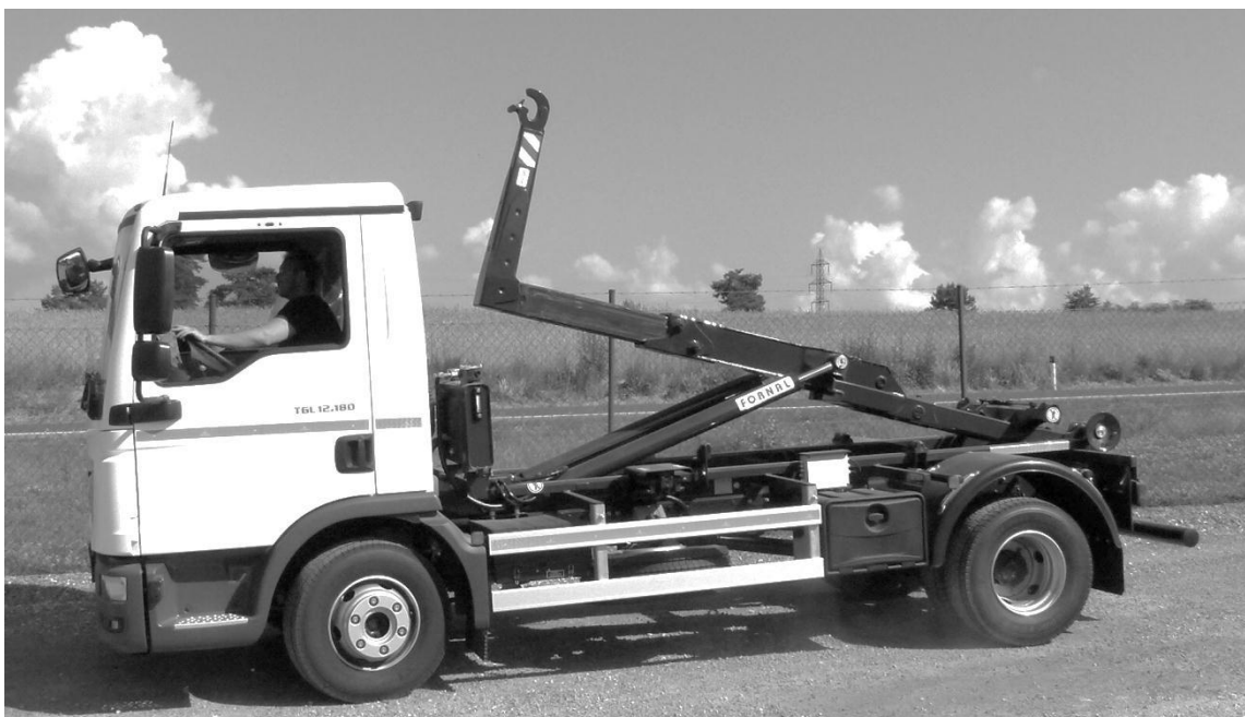
Obrázek 6: Nákladní automobil v úpravě pro přepravu kontejnerů
