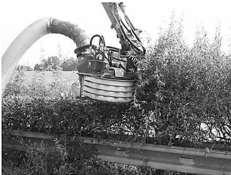
Obrázek 84: Ořezávač dřevin s drcením
