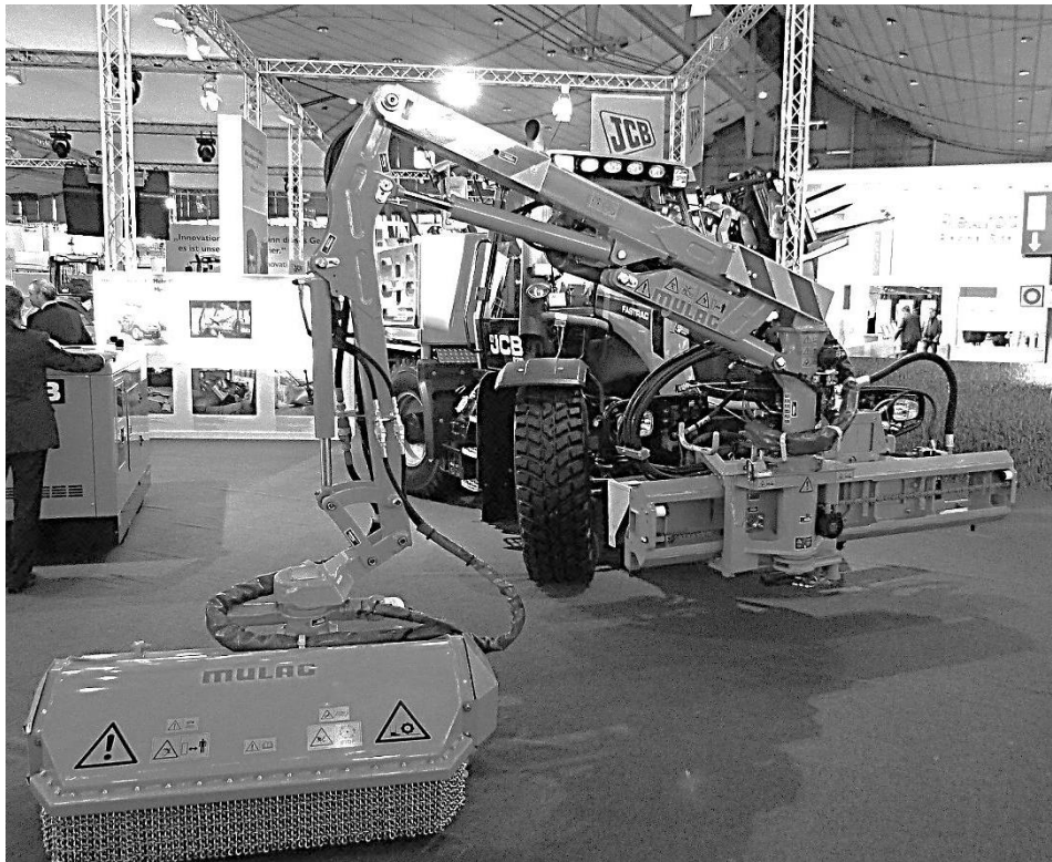
Obrázek 59: Horizontální mulčovač na nosném rameni
