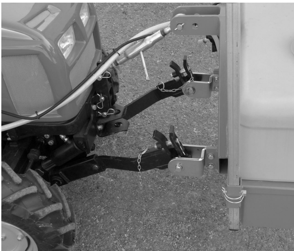
Obrázek 20: Přední třibodový závěs traktoru
