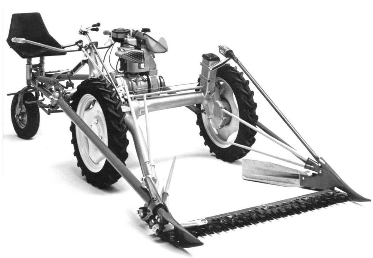
Obrázek 50: Žací lišta s protiběžnými kosami pro údržbu extenzivních travních ploch
