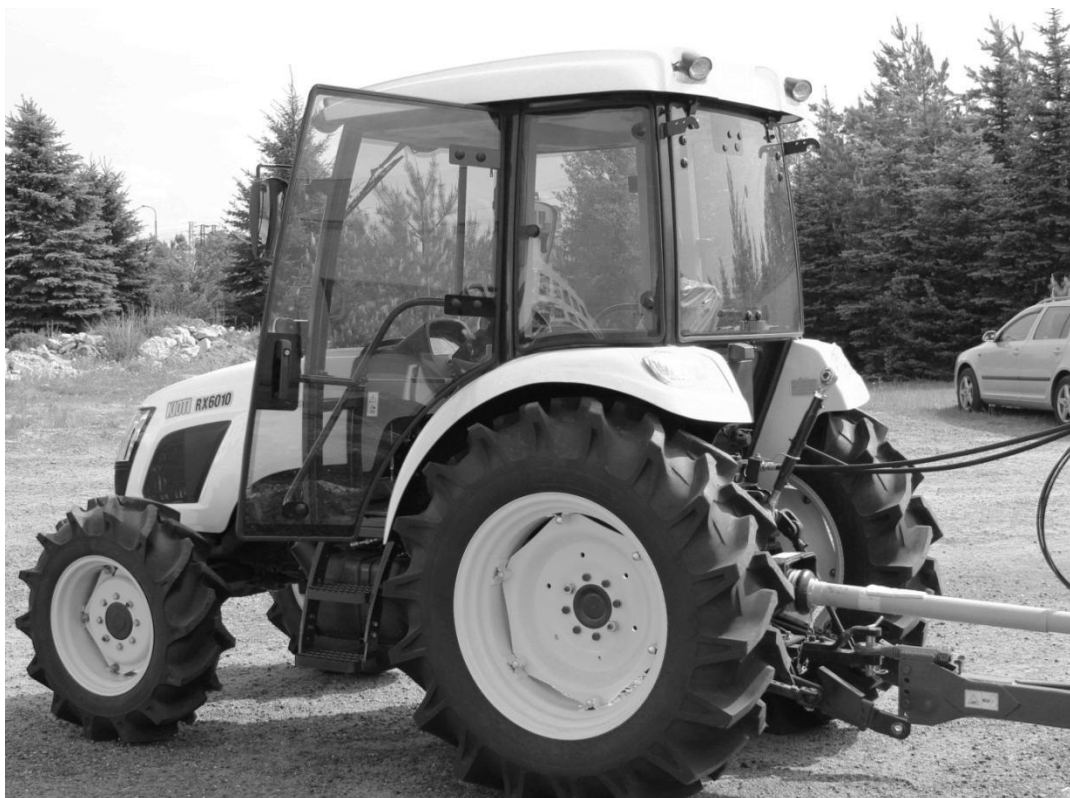
Obrázek 23: Dolní závěs s připojením kloubového hřídele
