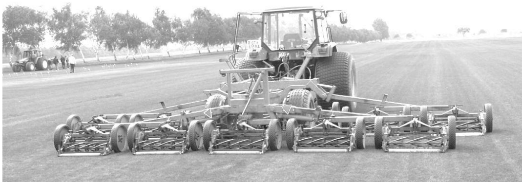
Obrázek 51: Žací stroj s vřetenovým žacím ústrojím
