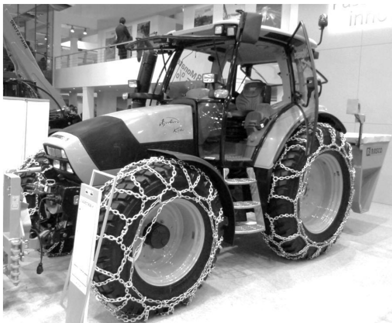
Obrázek 1: Univerzální kolový traktor v provedení pro komunální sféru
