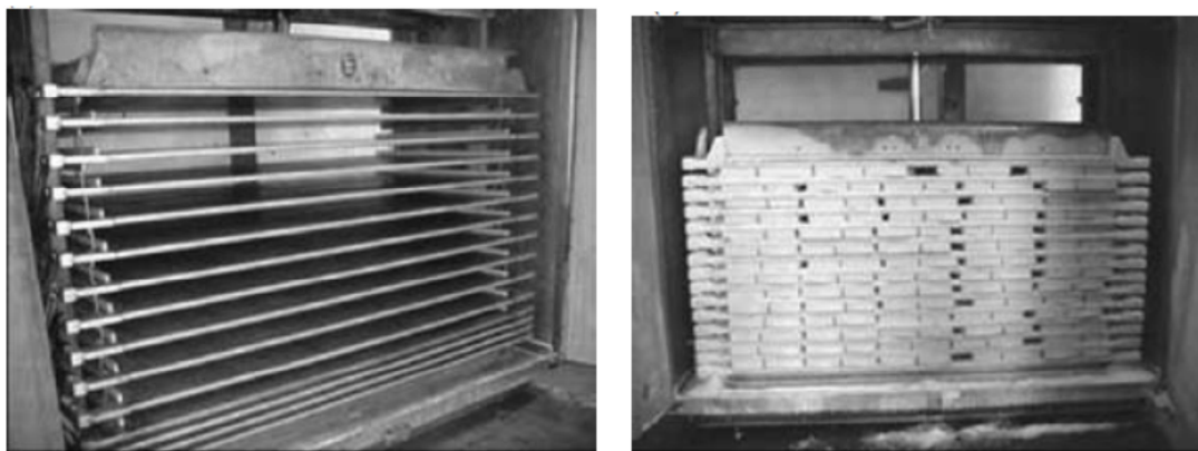
Obr. 3: Kontaktní zmrazovač bez vloženého produktu (vlevo), po hydraulickém stlačení (vpravo)
