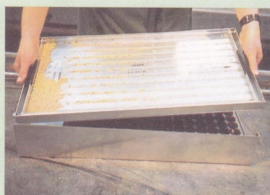
Přebytečná semena se sesypou do zásobního prostoru a zůstávají k dispozici pro další výsevy.
