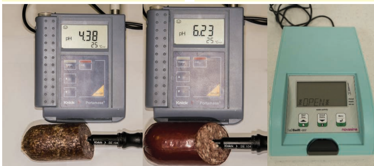
Obr. 19: Trvanlivost poličanů a jiných fermentů je dána i díky nižšímu pH (vlevo), než je tomu u vysočin (uprostřed). Parametrem, který se u obou výrobků sleduje, je ovšem a_w (aktivita vody, a_w -metr vpravo).
