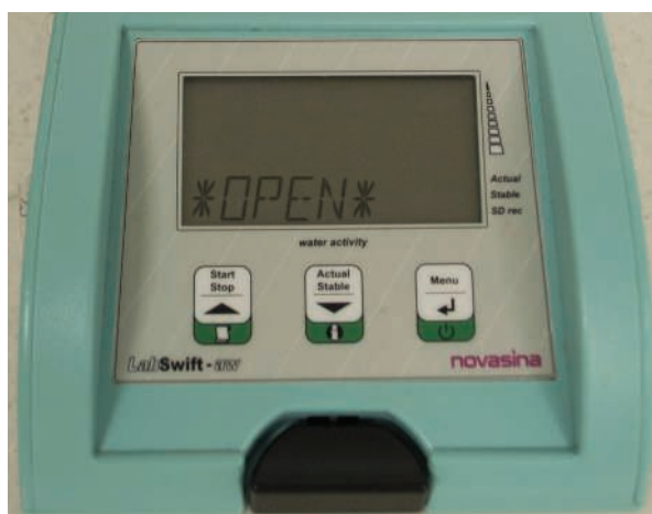
Obr. 36: a_w -metr je přístroj na měření aktivity vody a_w (water activity).
