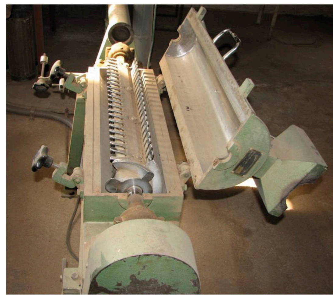
Obr. 2: Palcová odkvídlovačka pro suché odkvídlování. Ve stroji se otáčí hřídel se systémem kolků, rozložených ve třech radách.
