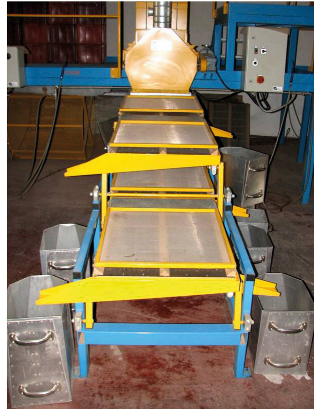
Obr. 7: Jemná čistička BCC separuje pomocí sítí drobné nečistoty a frakce semen podle velikosti.
