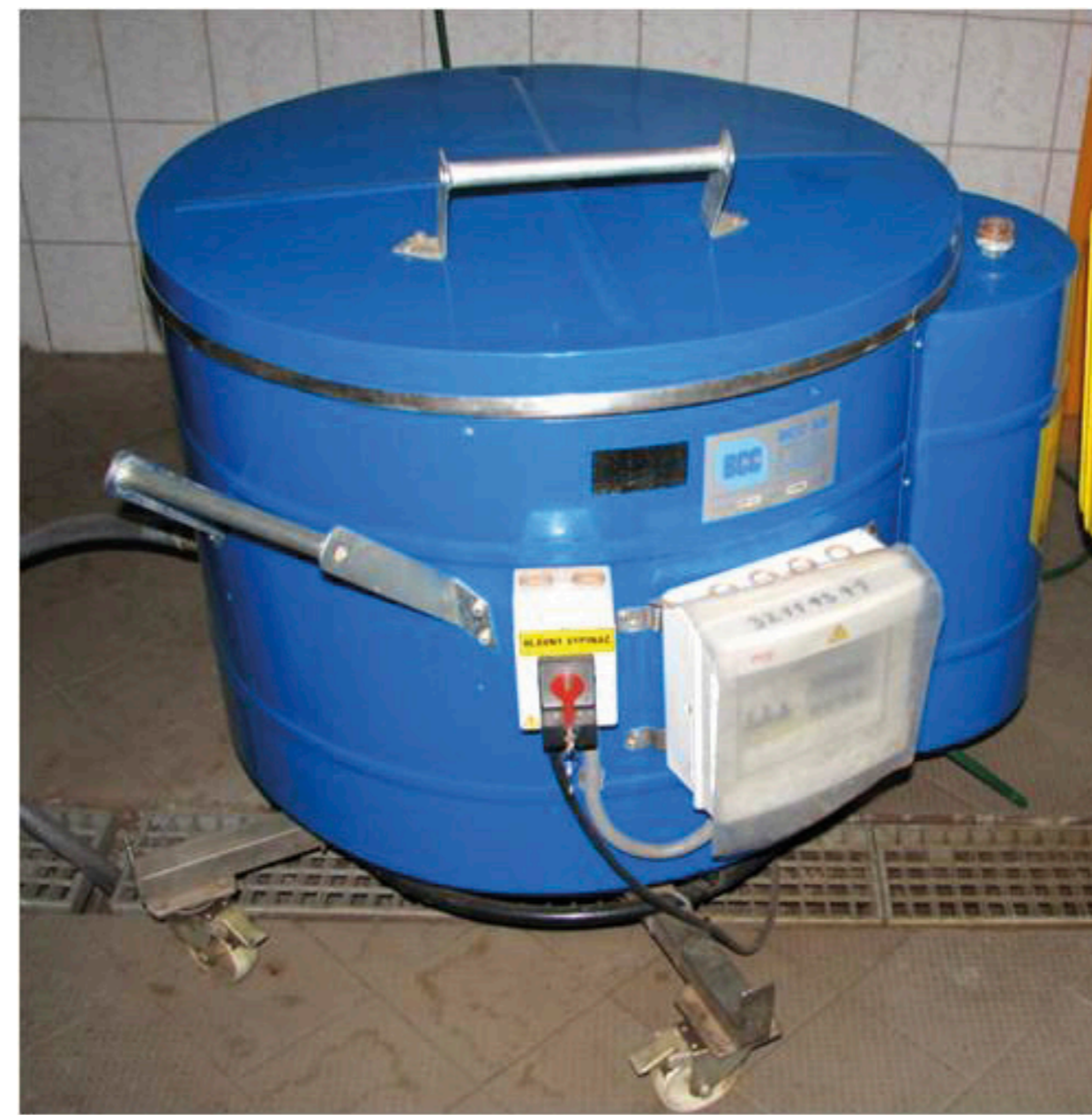
Obr. 9: Kotel na termoterapii pojme až 100 kg semen dubu, které udržuje 2,5 hodiny při teplotě 41°C.
