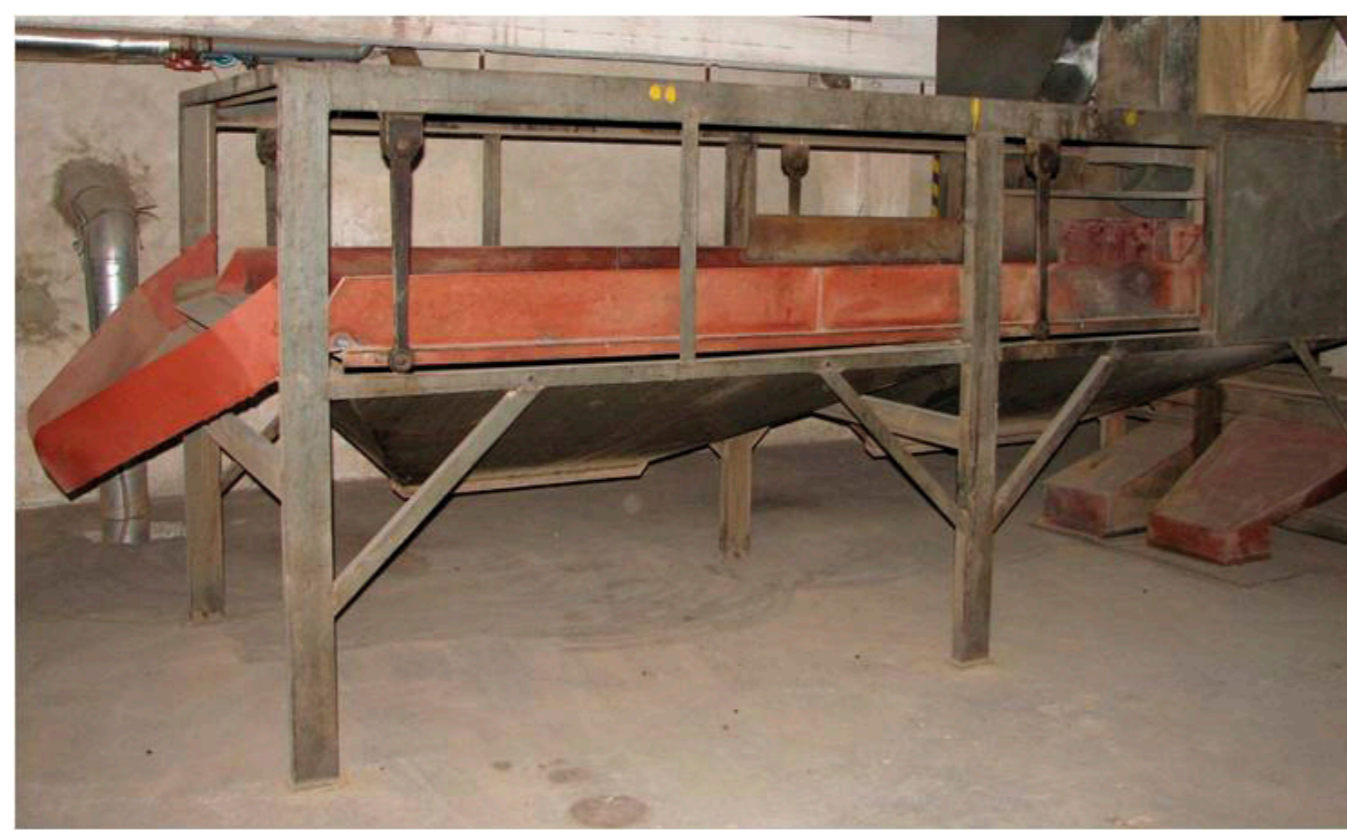
Obr. 3, 4: Kombinovaná etážová pásová luštnírna, pracující na principu proti sobě jdoucích pásů včetně vytřásače.
