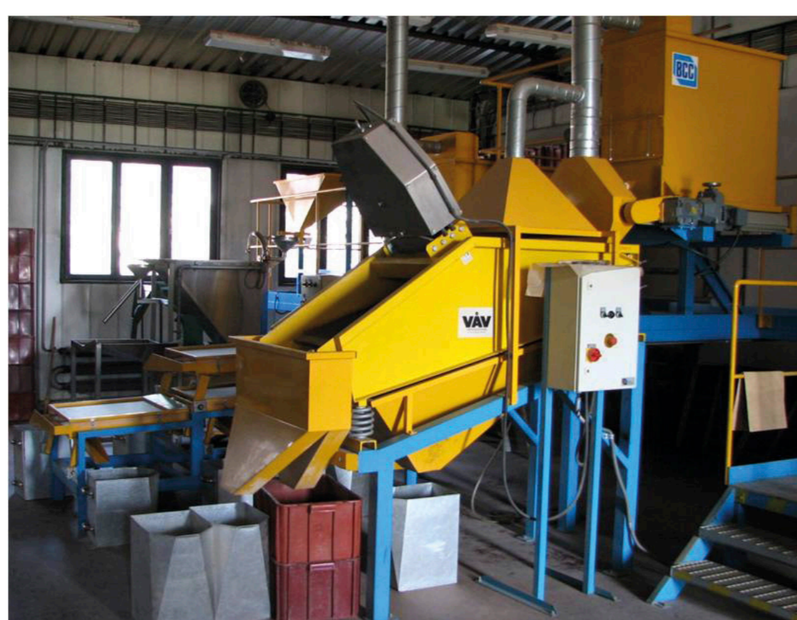
Obr. 6: Třídící hrubých nečistot BCC odděluje jehlice, větvičky, šupiny apod.
