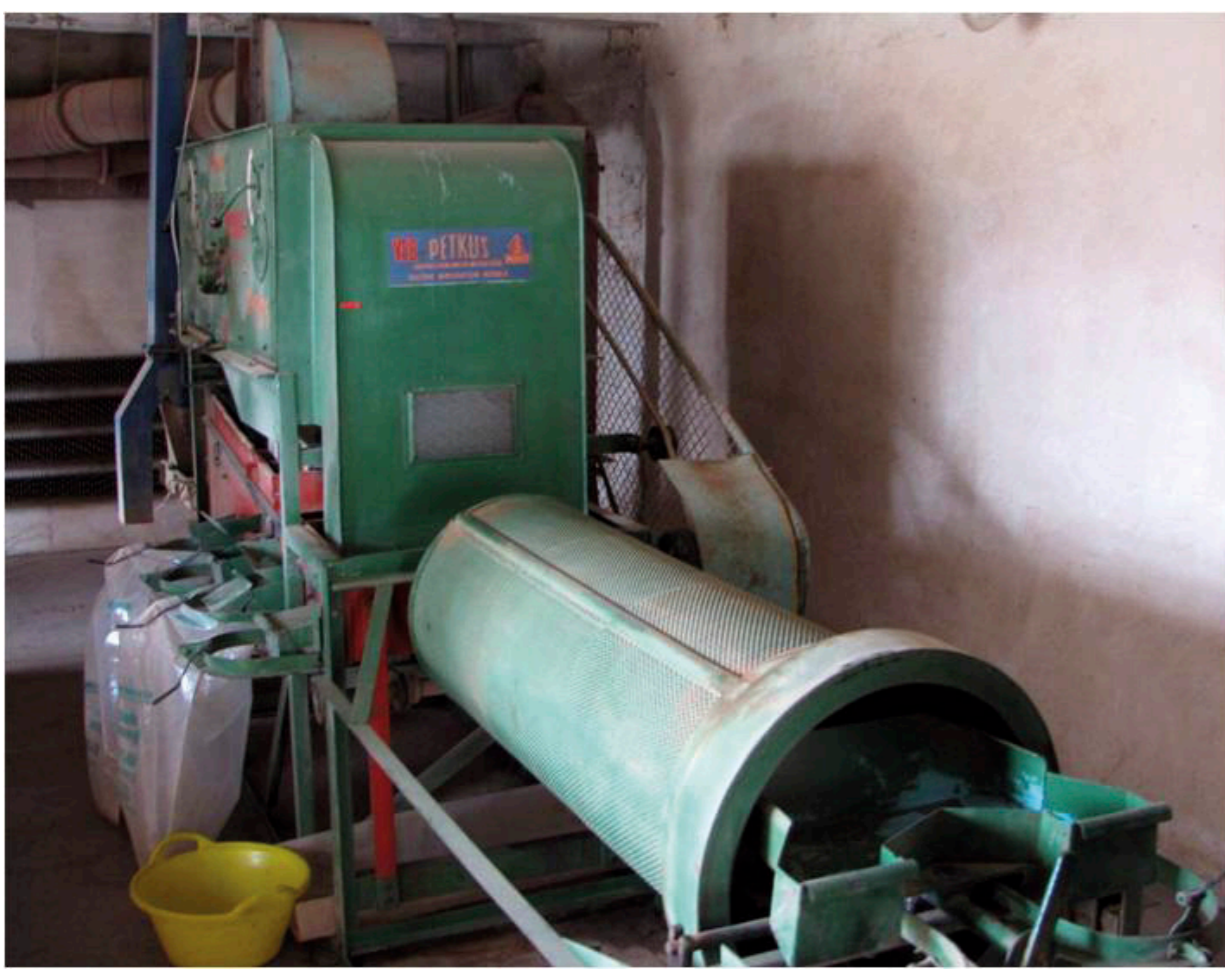
Obr. 1: Dočistovací zařízení Petkus. Soustava sítí, které vibračním způsobem třídí semeno podle hmotnosti a zároveň podle velikosti
