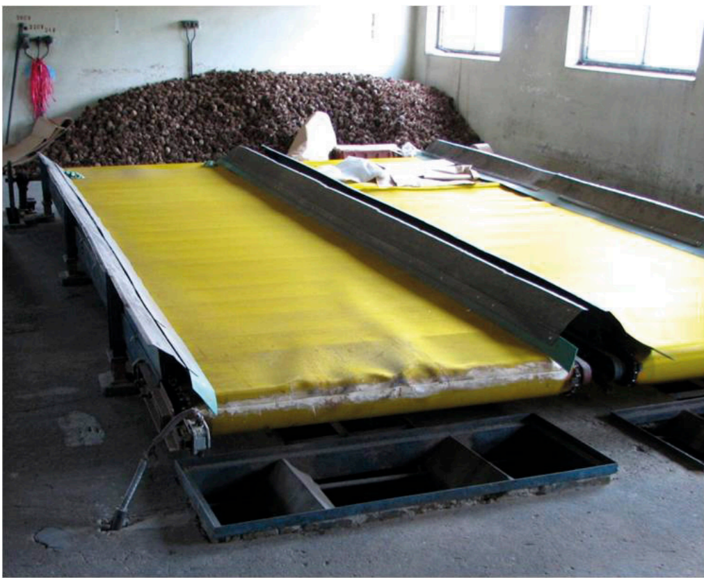
Obr. 3, 4: Kombinovaná etážová pásová luštnírna, pracující na principu proti sobě jdoucích pásů včetně vytřásače.
