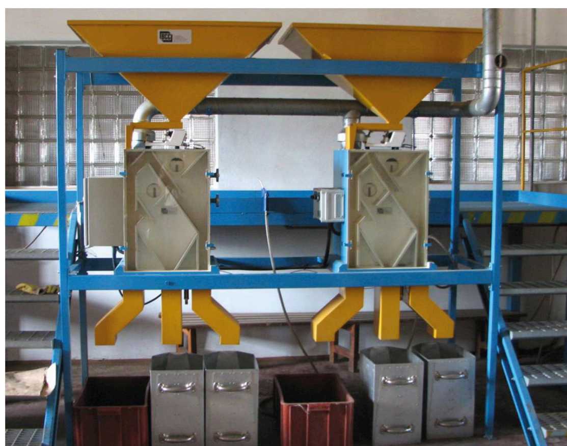
Obr. 5: Gravitační separátory pracující na principu hmotnostní separace způsobené proudem vzduchu.
