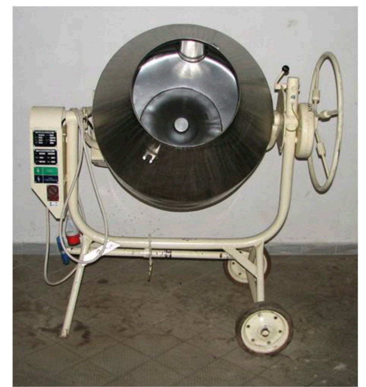
Obr. 10: Speciálně upravená míchačka se používá na suché moření osiva.
