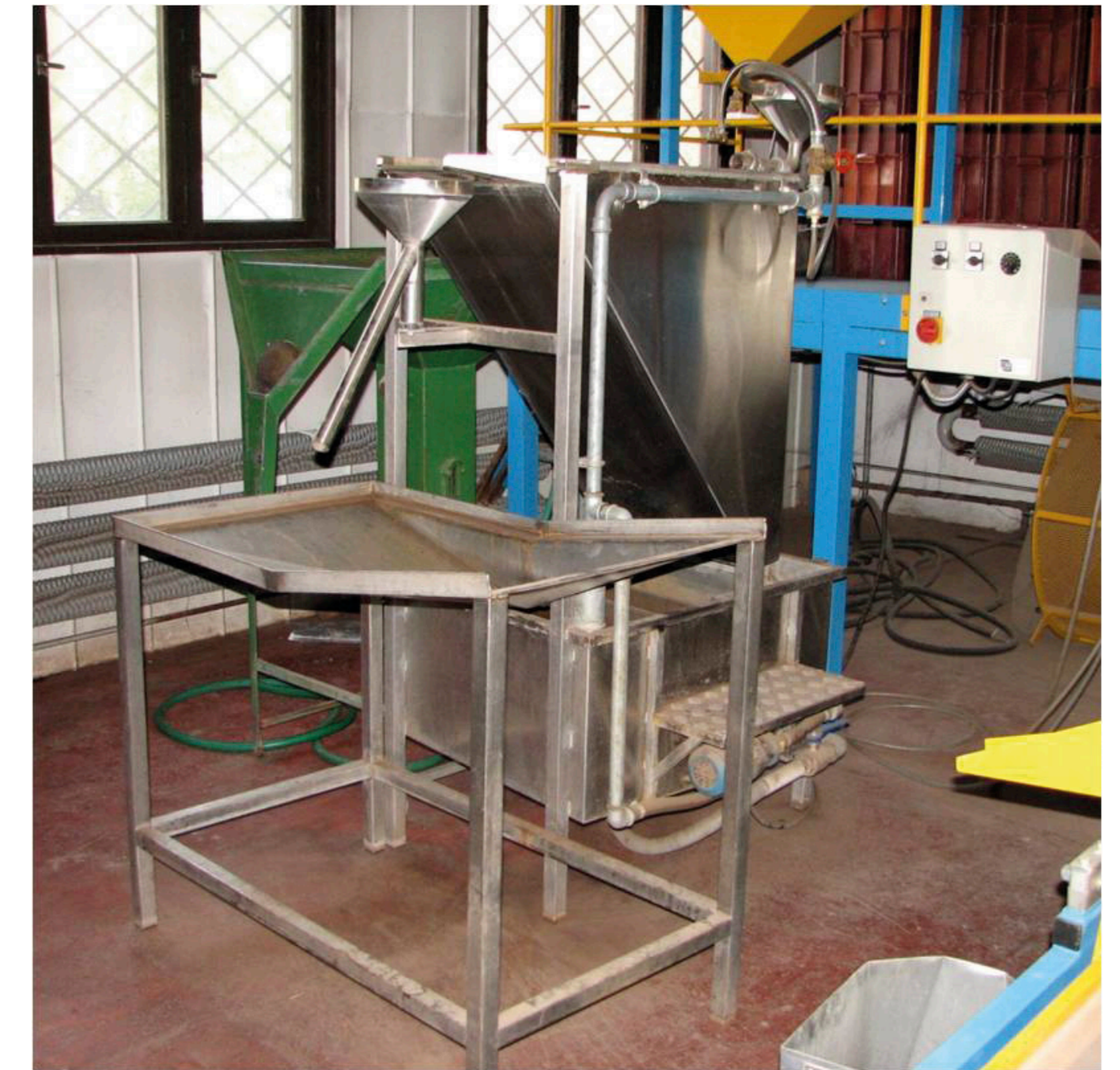
Obr. 8: Plavící zařízení slouží pro následné dočištění semen, kde po mechanickém luštění zůstává v semenech hodně úlomků, šupin a prázdných semen.
