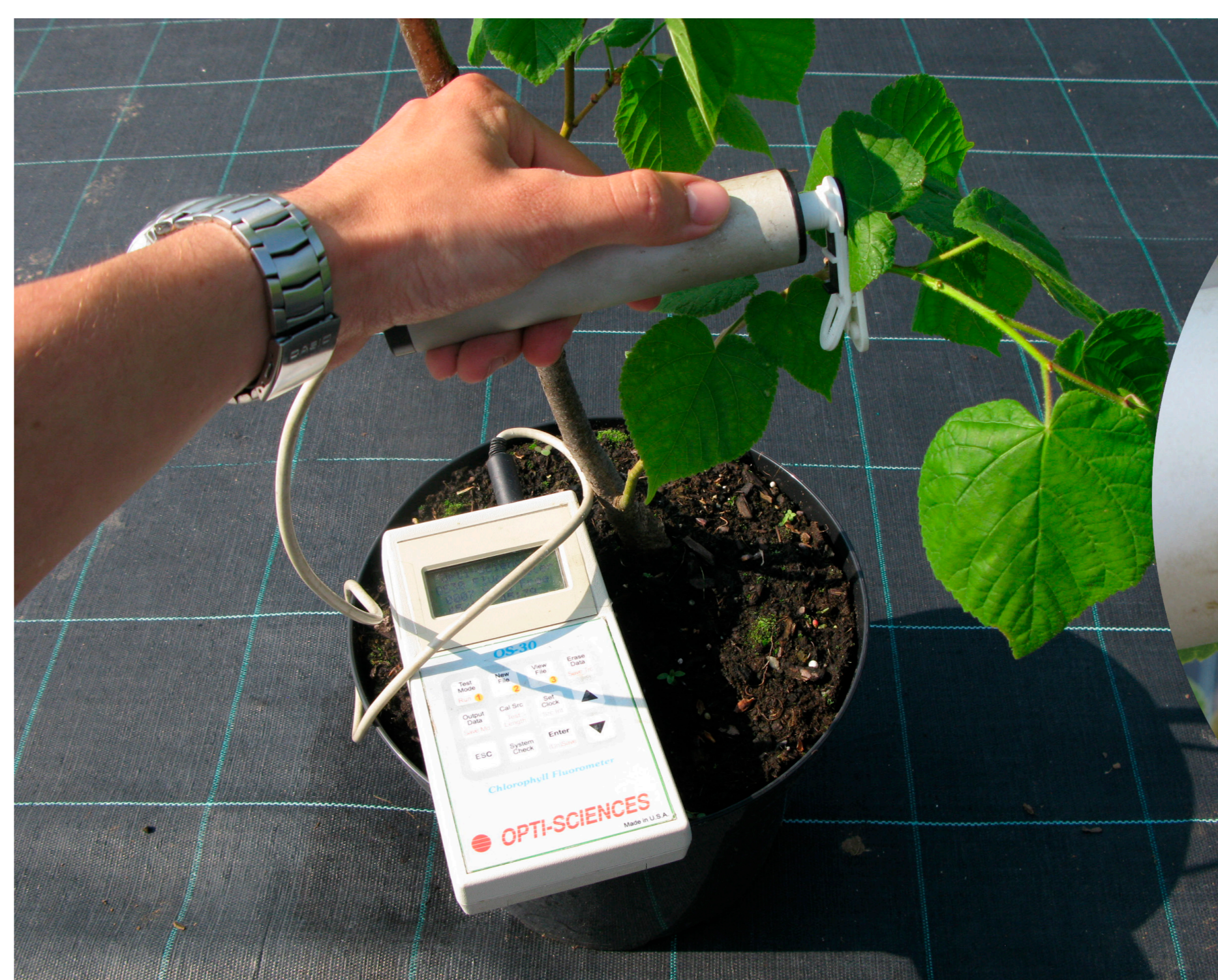
Obr. 2: Ukázka měření fluorescence chlorofylu s přístrojem Chlorophyll Fluorometer OS-30
