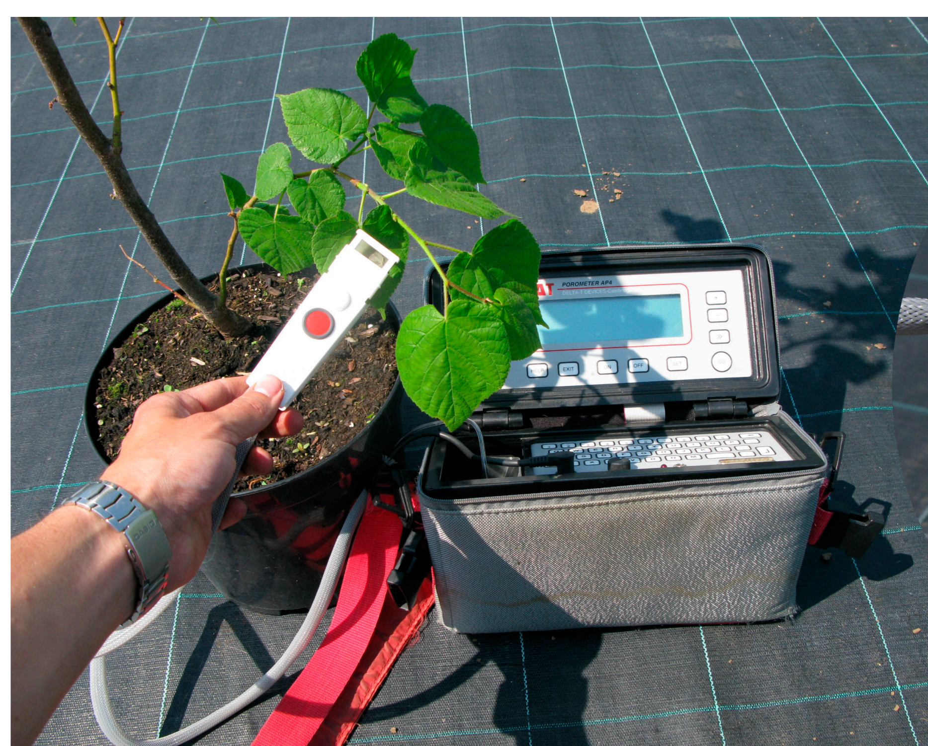
Obr. 3: Ukázka měření průduchové vodivosti s přístrojem Porometr AP 4
