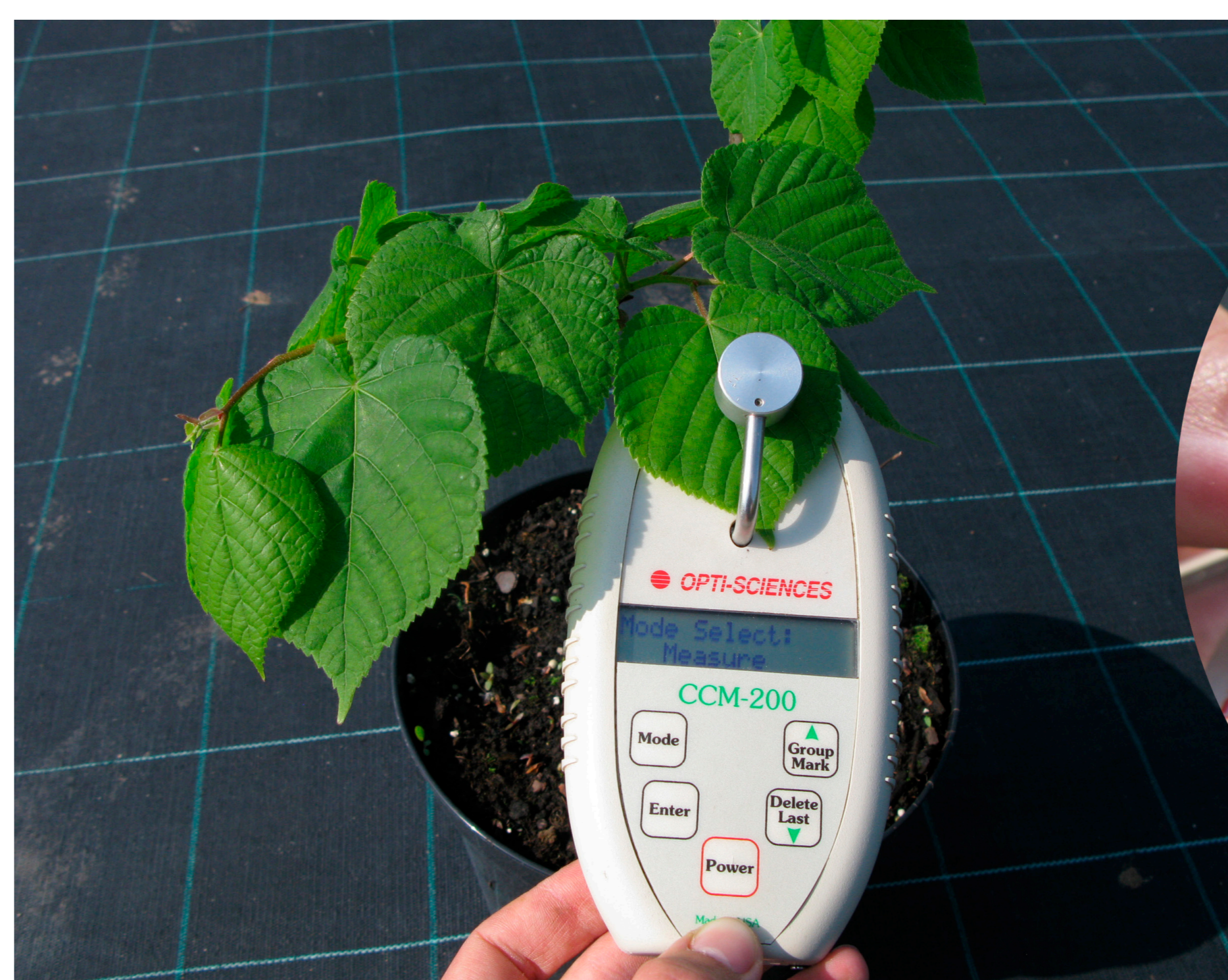
Obr. 1: Ukázka měření obsahu chlorofylu s přístrojem Chlorophyll Content Meter (CCM-200)
