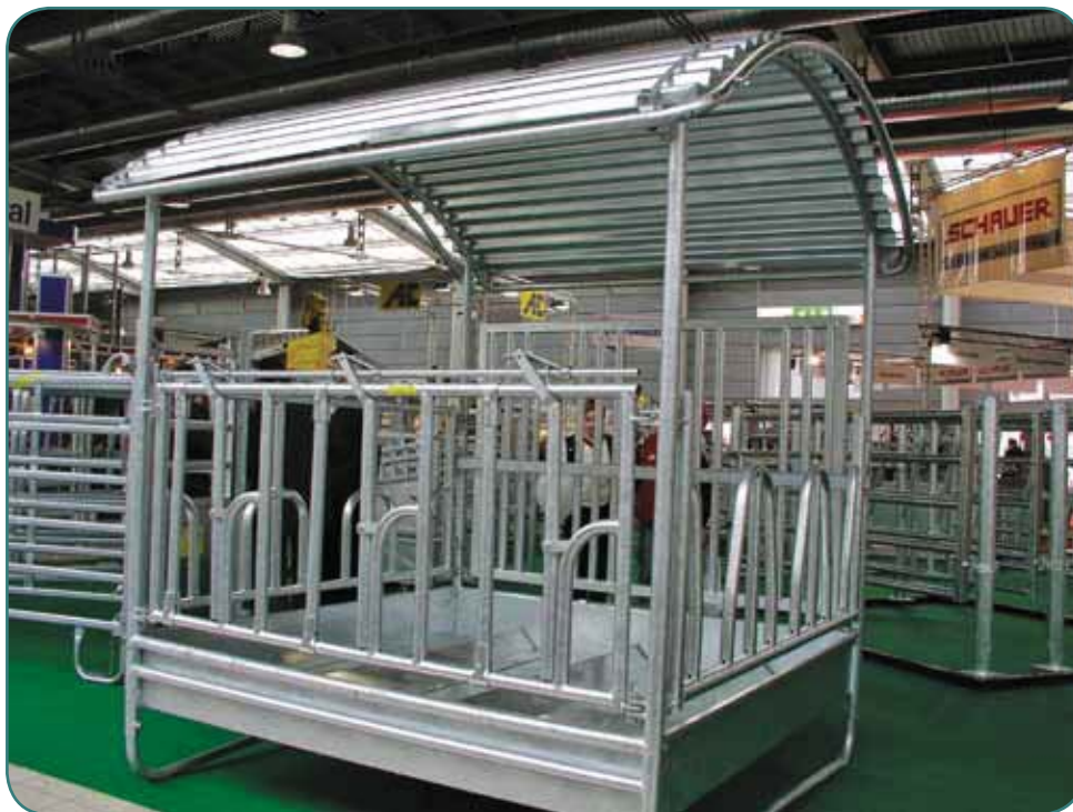
Obr. 5.8: Příkrmiště s vyvýšenou spodní plochou zabraňující plesnivění sena
