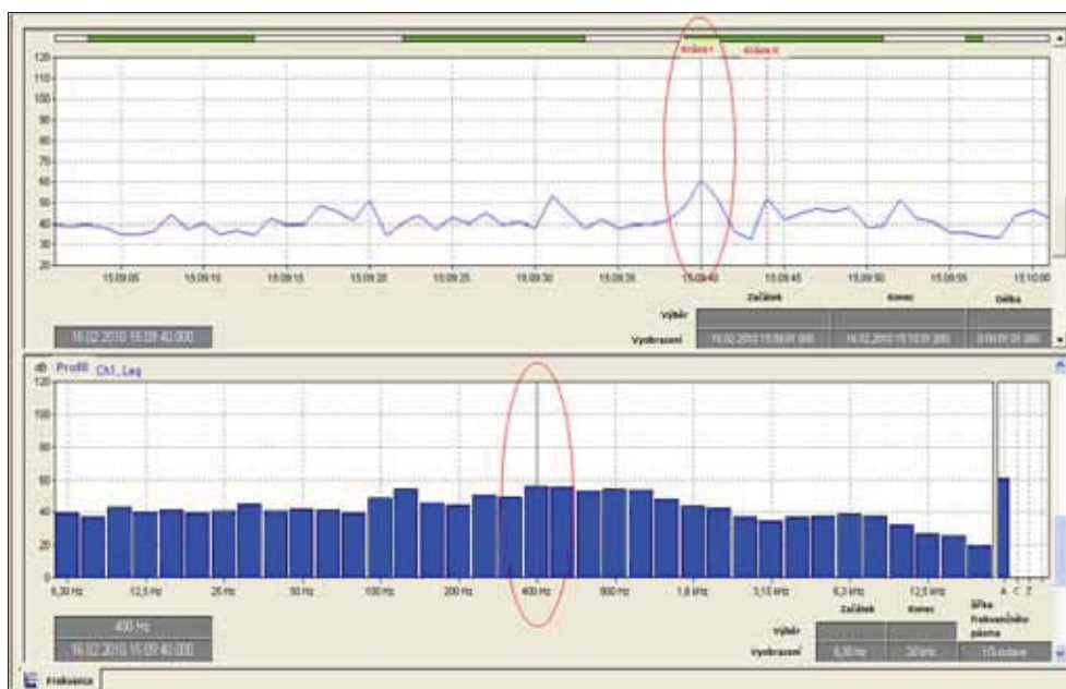
Obrázek 66: Časový průběh hladiny a frekvenční analýza měření zvuku ve stáji skotu. Značky ukazují zvuky krav prostřednictvím krávy I (vrchol při 400 Hz)
