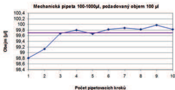
Obr. 2: Vliv předvlhčení špičky na správný objem
