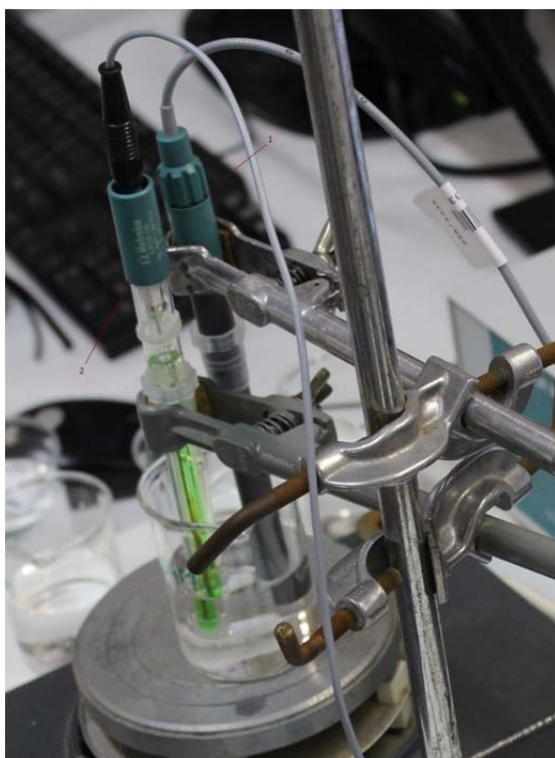
Obr. 2. Zapojení elektrod pro měření ve vzorku 1. pracovní elektroda ( \text{Cl}^- ) 2. Referenční elektroda
