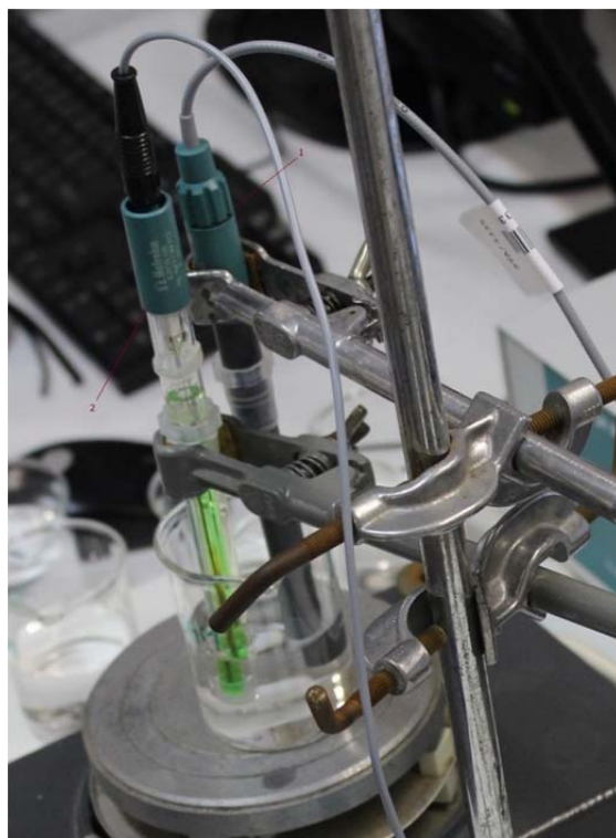
Obr 3. Zapojení elektrod pro měření ve vzorku 1. pracovní elektroda ( \text{Ca}^{2+} ) 2. Referenční elektroda
