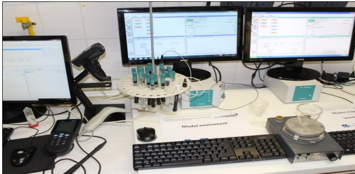
Technická infrastruktura využívající modul environment. Jednotlivé moduly umožňují provedení analýzy vybraných iontů. Celý systém je kontrolovaný počítačem, včetně vyhodnocení získaných experimentálních dat.
