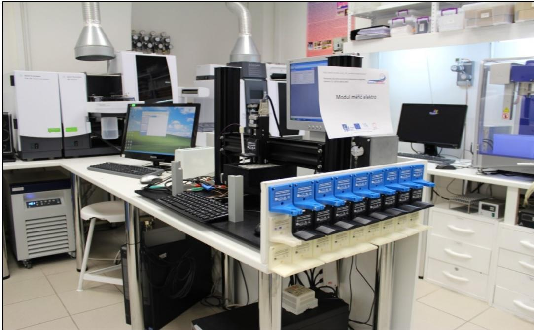
*Technická infrastruktura využívající modul měřič elektro (elektrochemický detekční systém v automatizovaném režimu). Modul aplikujeme na využití detekce iontů těžkých kovů. Systém umožňuje automatickou detekci kademnatých iontů. Technicky je tvořen robotickým ramenem, umožňujícím přesun elektrodového holderu pro různé vzorky. Zařízení je dále tvořeno speciálním potenciostatem pro vyhodnocování získaných dat.*
