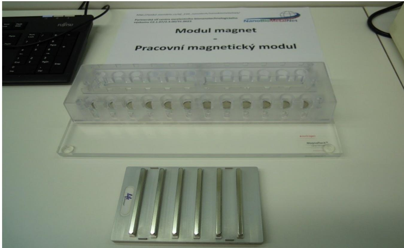
*Modul magnet – pracovní magnetický modul je aplikován pro práci s různými typy magnetizovatelných částic.*
