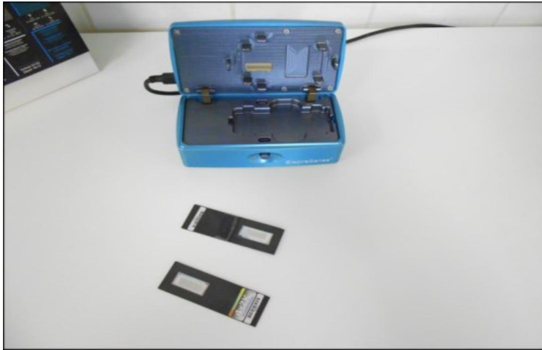
*Technická infrastruktura využívající modul magnet – Izolátor paramagnetických a superparamagnetických částic. Příprava sklíček pro hybridizační experiment, optimalizace celého postupu. Aplikace připraveného vzorku, za využití izolátoru paramagnetických a superparamagnetických částic pro izolované nukleové kyseliny.*
