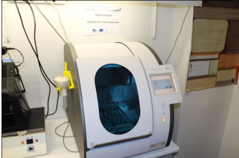
*Moduly slouží pro automatickou izolaci nukleových kyselin. Izolace genomové nukleové kyseliny z reálného vzorku bez nutnosti náročné lidské obsluhy. Kvalita získaných nukleových kyselin je následně ověřena moduly elektro a foto.*
