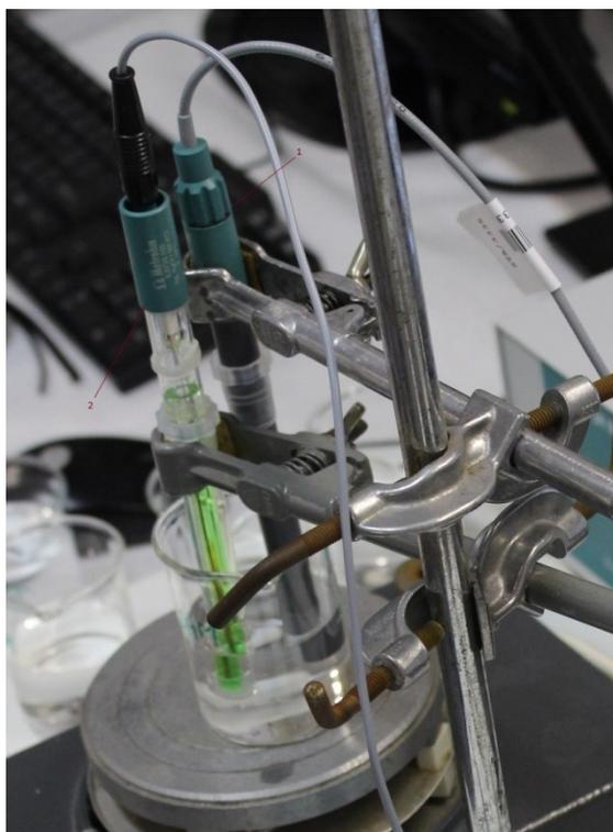
Obr 3. Zapojení elektrod pro měření ve vzorku 1. pracovní elektroda (Cl<sup>-</sup>) 2. Referenční elektroda
