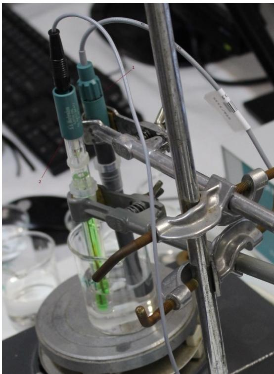
Obr 3. Zapojení elektrod pro měření ve vzorku 1. pracovní elektroda (Br<sup>-</sup>) 2. Referenční elektroda
