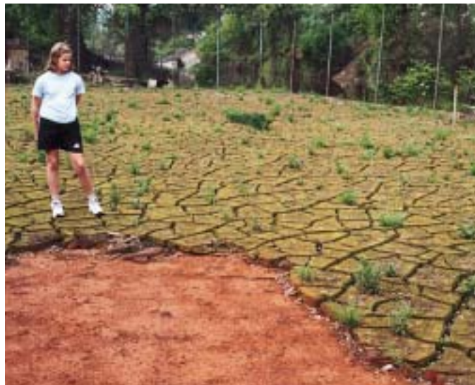
Usazenina vápnitého jílu a kalu na tenisovém hřišti na Libeňském ostrově, 10 měsíců po povodni Foto R. Mikuláš, červen 2003
