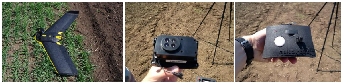
Obr. 23 Bezpilotní prostředek Sensefly eBee (vlevo) a senzor MULTISPEC4C se čtyřmi optickými čočkami pro jednotlivé spektrální pásma (foto uprostřed) a čidlem příchozí radiace (foto vpravo)
