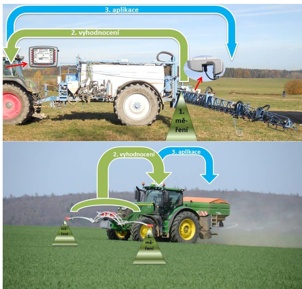
Obr. 2 Jednotlivé kroky u online systému aplikace postřikovačem a rozmetadlem. Instalace senzorů na ramena postřikovače vede ve většině případů k mírnému zpoždění reakce aplikace postřikové látky na naměřené hodnoty (upravil Neudert)
