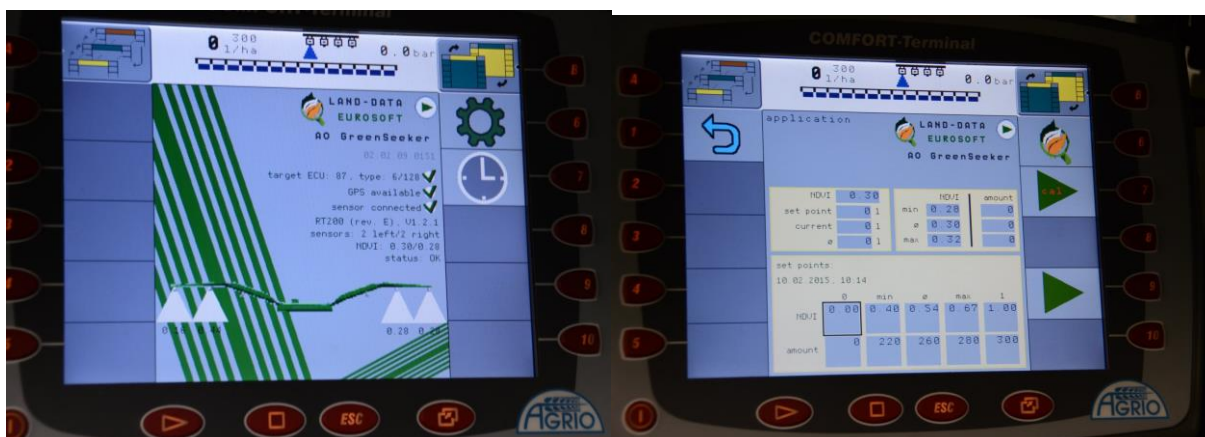
Obr. 14 Obrazovka AO Greenseeker ISOBOX s přehledem stavu senzorových jednotek a aktuální hodnotou NDVI (vlevo). Na obrázku vpravo je nabídka pro volbu dávek hnojiva, kalibraci a spuštění variabilního dávkování.
