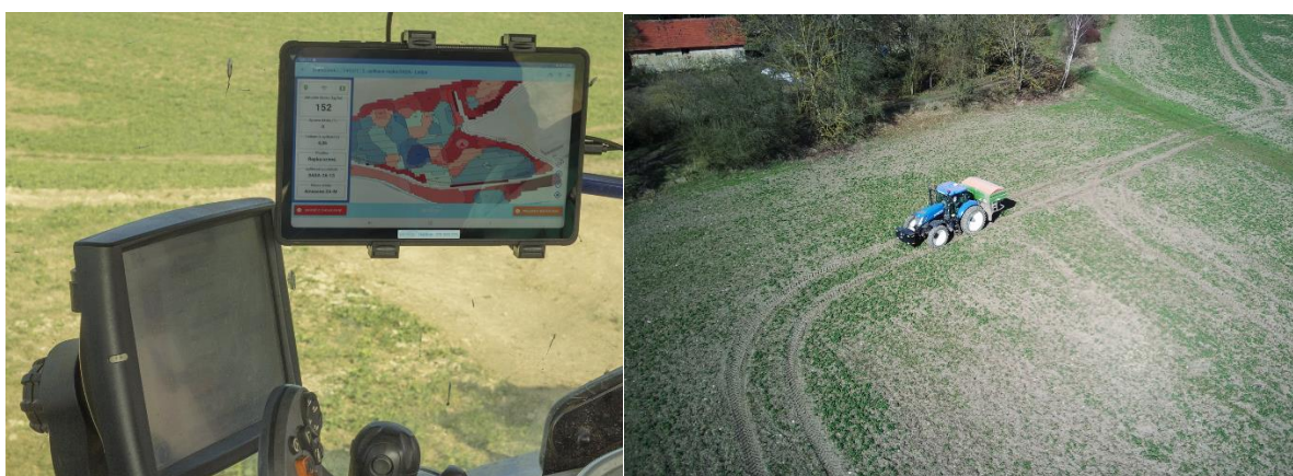
Obr. 10 Nainstalovaný terminál Varistar One v kabině traktoru AGRA Řisuty s.r.o. se zobrazenou aplikační mapou pro rozmetadlo pevných minerálních hnojiv Amzone ZA-M (vlevo) a záběr na soupravu při aplikaci (foto: Varistar s.r.o.)
