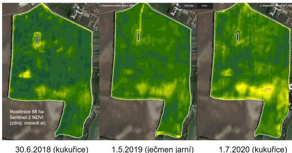
Obr. 2 Vymezení produkčních zón z družicových snímků vychází z hodnocení zapojení stavu porostů v jednotlivých ročnících – méně produkční místa vykazují opakovaně nižší hodnoty vegetačních indexů (příklad NDVI ze Sentinel-2)
