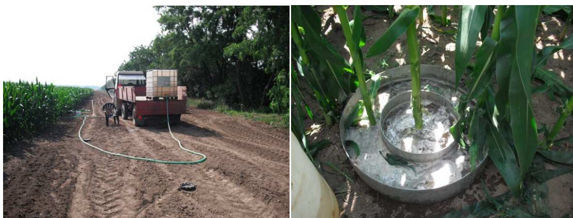
Obr. 1: Měření infiltrace vody do půdy v porostu kukuřice (foto V. Lukas)
