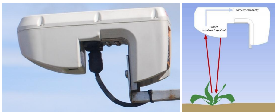
Obr. 35 Přístroj GreenSeeker® (Foto V.Lukas) a princip měření přístroje ( www.trimble.com )
