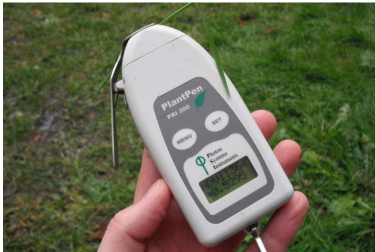
Obr. 20 Kapesního přístroje PSI PlantPen pro kontaktní měření NDVI (foto V. Lukas)
