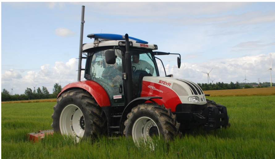
Obr. 22 Yara N-Sensor instalovaný na kabině traktoru (foto: V. Lukas)
