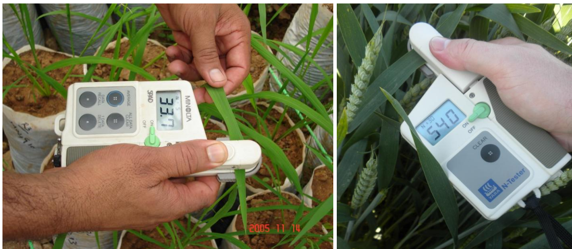
Obr. 15 Chlorofylmetr SPAD 502 (Minolta Corp., Tokyo, Japan, foto: B. B. Rosyara) a Yara N-tester (foto: P. Ryant)
