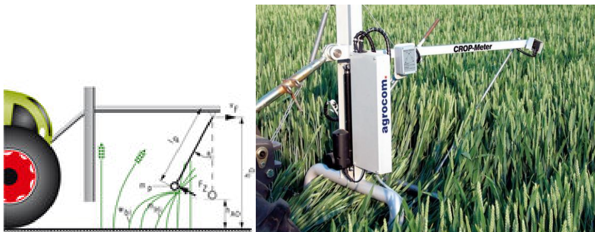
Obr. 28 Princip měření Crop-meteru a jeho při použití v porostu obilnin ( www.agrocom.de )
