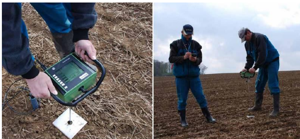
Obr. 12 Měření penetrometrického odporu ručním penetrem
