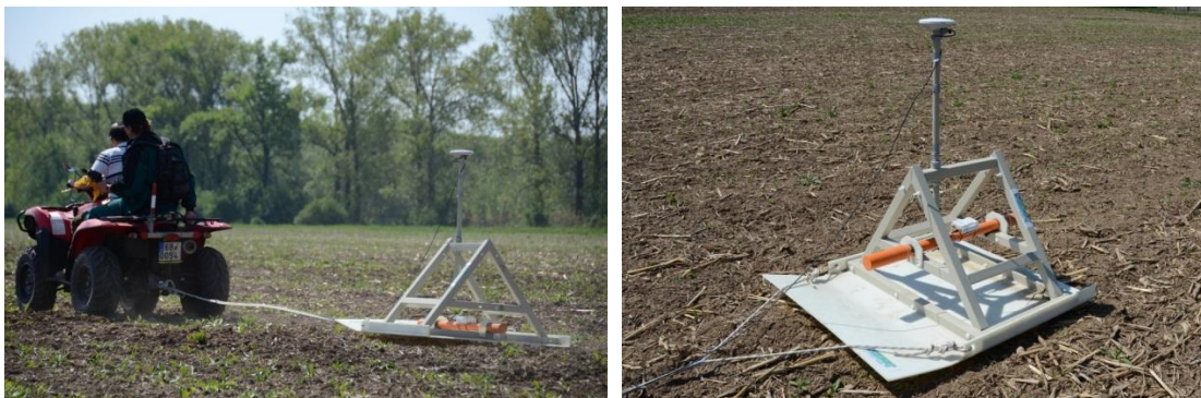
Obr. 9 Měření EC půdy přístrojem CMD taženým za terénní čtyřkolkou a detail na plastovou konstrukci aparatury s měřícím přístrojem
