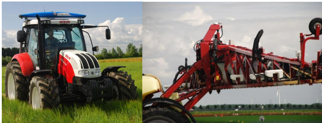
Obr. 17 Yara N-sensor namontovaný na kabině traktoru a instalace několika NTech GreenSeeker přístrojů na ramenu postřikovače
