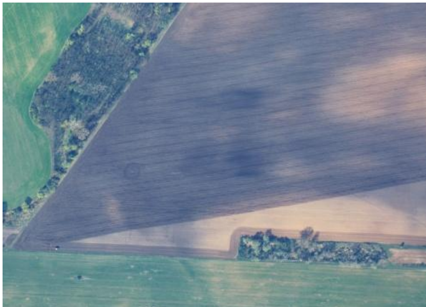
Obr. 14 Příklad leteckého snímku pořízeného při předsetové přípravě půdy. Použití snímku pro identifikaci prostorové variability půdy znemožňuje zpracování půdy pouze na části pozemku
