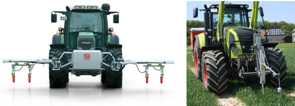
Obr. 18 Přístroje Fritzmeier MiniVeg (vlevo) a Claas Cropmeter (vpravo) namontované na předním závěsu traktoru. Foto: www stránky výrobců.
