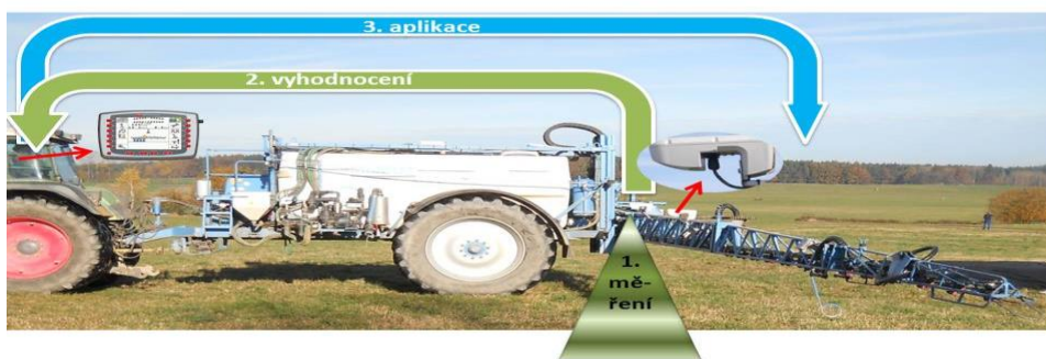
Obr. 1 Jednotlivé kroky u online systému aplikace postřikovačem (upravil Neudert)
