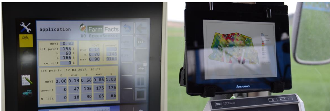
Obr. 10 Obrazovka AO Greenseeker ISOBOX s nabídkou pro volbu nastavení systému, dávkování hnojiva, kalibraci a ovládání variabilního dávkování (vlevo) a obrazovka tabletu s aplikační mapou pro kontrolu jezdů testovací soupravy (vpravo)
